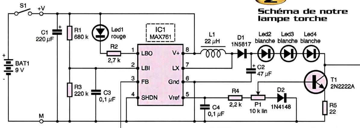
à 12V environ par l'alimentation à découpage, et cette tension est utilisée pour alimenter les trois LED montées en série, sous un courant réglable de manière continue au moyen d'un potentiomètre. Malgré cette apparente «complexité», un seul circuit intégré huit pattes aisément disponible et peu coûteux suffit à réaliser à lui seul les deux fonctions, comme nous pouvons le découvrir maintenant à l'examen de la **figure 2**.
