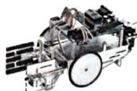
**Gripper** : Une superbe extension pour le BOE-bot. La pince commandée par un servomoteur est munie de capteurs infrarouges capables de repérer des objets (taille d'une balle de ping pong), de les saisir et de les déplacer. Livré sans le BOE-Bot.
