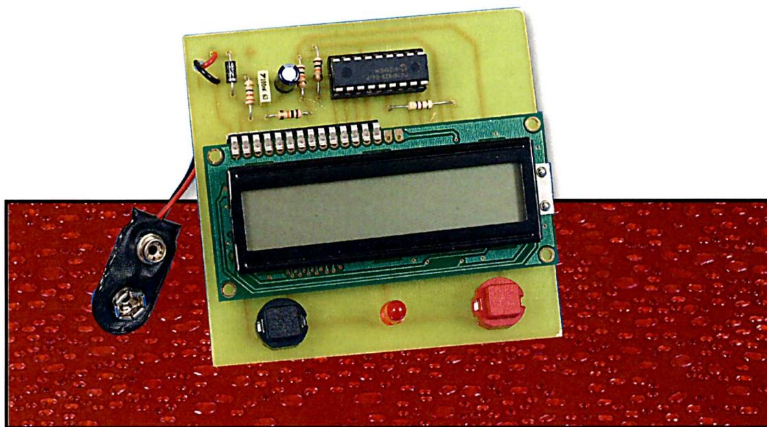
**Le montage décrit ci-dessous mesure la rapidité des réflexes d'un ou deux joueurs : ceux-ci doivent appuyer sur leur bouton-poussoir respectif le plus rapidement possible après l'allumage d'une LED. Le temps de réaction, en centième de seconde, et le nom du plus rapide s'inscrit alors sur l'afficheur. C'est un jeu assez simple, rapidement construit à peu de frais et dont l'intérêt réside aussi dans la mise en œuvre d'un microcontrôleur PIC16F628 et d'un afficheur LCD.**
