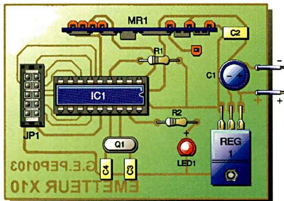
**2** Circuit imprimé de l'émetteur **4** Implantation de ses composants
