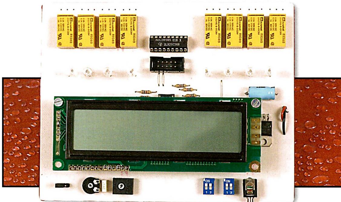
**Le séquenceur ou défileur est un appareil qui permet de multiplier les possibilités d'action des personnes qui ne peuvent utiliser qu'un seul et unique contacteur. Il est prévu, dans le cadre de ce dossier, à faciliter l'utilisation des interfaces souris et contrôle d'environnement mais peut tout à fait être employé avec d'autres applications grâce aux relais dont il est équipé.**
