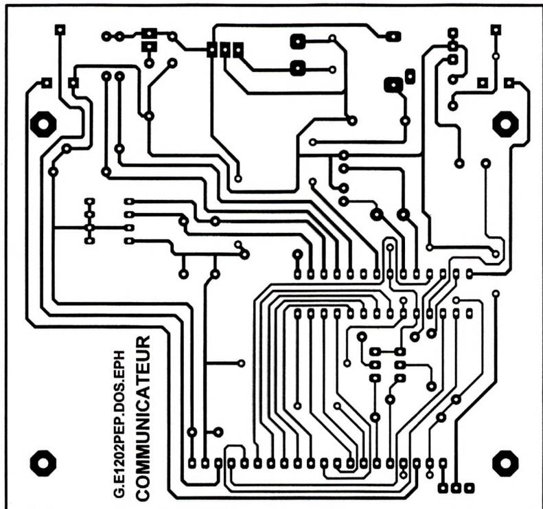
**6** Circuit imprimé du communicateur
