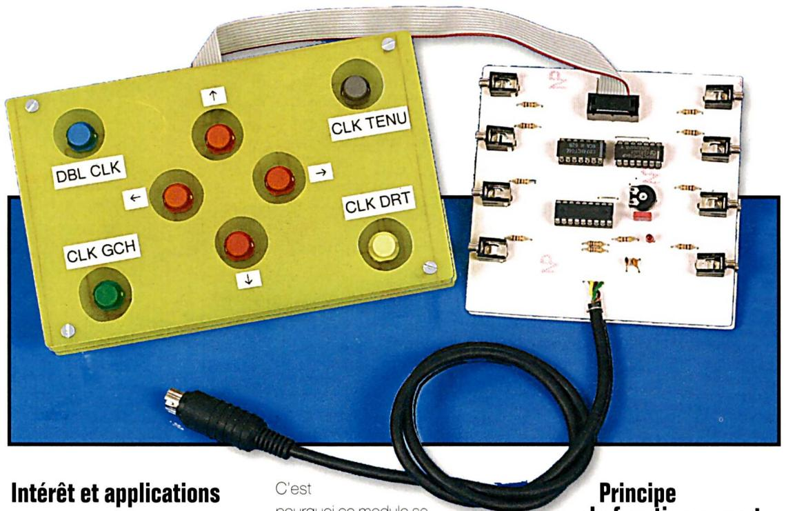
**Le montage proposé ici a pour fonction de remplacer la souris de l'ordinateur. Il propose, en effet, de rapporter sur des contacteurs ou sur un clavier à guide doigts, toutes les fonctions que propose une souris. Vous retrouverez donc les déplacements, les clics gauche, droit ainsi que les doubles clics et clic maintenu. Ce montage est également prévu pour être piloté par le micro joystick.**
