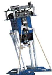
**The Toddler** est un robot bipède fonctionnant grâce à deux servomoteurs et un BASIC Stamp 2 (monté en surface sur la carte du Toddler). C'est un kit de qualité dont le châssis est en aluminium. Il mesure plus de 25 cm de haut. Il est livré avec une documentation en anglais importante (+600 pages) et aborde des sujets tels que : l'initiation au "contrôle autonome embarqué", l'apprentissage des schémas de marche de base (marche droite, tourner, figure en huit, ...).
