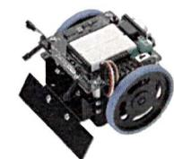
**SumoBot** est un robot prêt à participer aux compétitions de Mini-Sumo (elles consistent à repérer son adversaire et le repousser hors des limites du jeu). Le kit se compose d'une carte incluant un BASIC Stamp 2 monté en surface, toute la mécanique nécessaire, des capteurs infrarouges pour détecter ses adversaires et les bords du terrain de jeu. Livré avec une documentation sur le combat (mini-sumo) et la documentation du BASIC Stamp sur CD-ROM.
