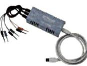
**Optascope 81M** : L'OPTAScope est un oscilloscope numérique se connectant sur le port USB d'un PC.
