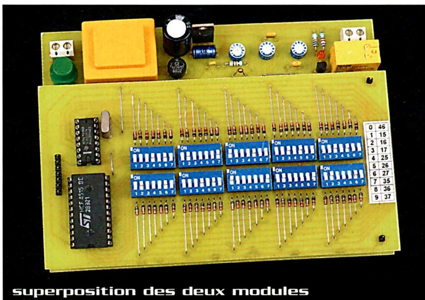
sortie S<sub>1</sub> concernée par le décodage d'une valeur binaire, présentée sur les entrées ABCD, présente un état bas. En situation de repos, la sortie S0 de IC<sub>4</sub> est donc au niveau logique 0. Les deux entrées de la porte NOR IV de IC<sub>3</sub> étant à l'état bas, la sortie de cette porte présente un état haut. Le compteur binaire IC<sub>6</sub>, dont l'entrée RESET est forcée à l'état haut, est donc bloqué.
