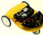
**KSR1** voiture robot guidée par capteurs sonores et de chocs. Change de direction au contact.
