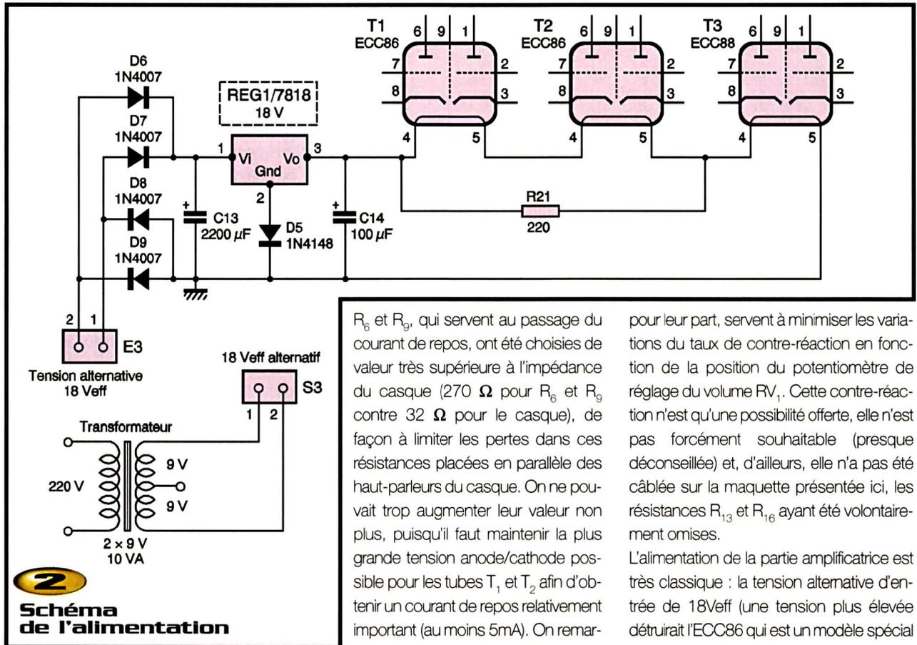
montées en parallèle, cela pour accroître la puissance disponible en sortie. Dans ce cas également, on utilise la polarisation automatique, la tension grille/cathode étant déterminée par le courant traversant  $R_5$  pour la voie droite et  $R_8$  pour la voie gauche, occasionnant une chute de tension proche de 0,45V dans ces résistances (si vous obtenez plus, c'est mieux). Les résistances
