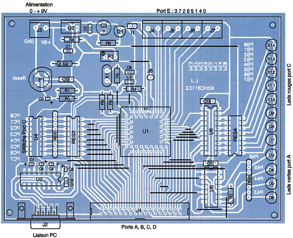
dent car il est directement relié au micro-contrôleur. Pensez à mettre des circuits de protection comme des buffers 74HCT541 ou 74HCT126, par exemple. Veillez aussi à limiter le courant si vous utilisez l'alimentation fournie par le connecteur. Le régulateur risquerait de surchauffer.
