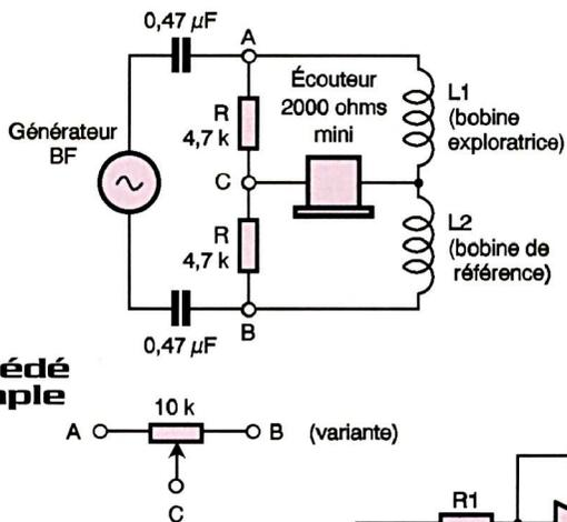
quelles que soient les circonstances. La réalisation d'un détecteur basé sur ce principe suppose la construction d'un générateur de fréquence et, éventuellement, d'un amplificateur destiné à attaquer un casque basse impédance ou un petit haut-parleur, avec un maximum de sensibilité. Il faut alors tenir compte du fait qu'il n'existe pas de masse commune entre la sortie du générateur et l'entrée de l'amplificateur, situation dont on peut s'accommoder en les alimentant par des piles distinctes.
