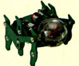
**KSR3** robot hexapode muni de capteurs IR et sonores se déplace sur 6 pattes.
