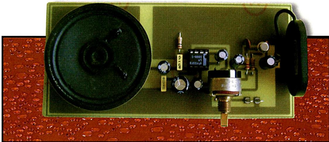
**Le détecteur de lignes électriques proposé dans le présent article est d'une grande simplicité, ce qui ne l'empêchera pas d'éviter de sectionner une gaine présente dans un mur lorsque l'on veut y percer un trou ou tout simplement y enfoncer un clou. Cela évitera la disjonction de toute l'installation électrique ou, pire encore, un risque d'électrocution**
