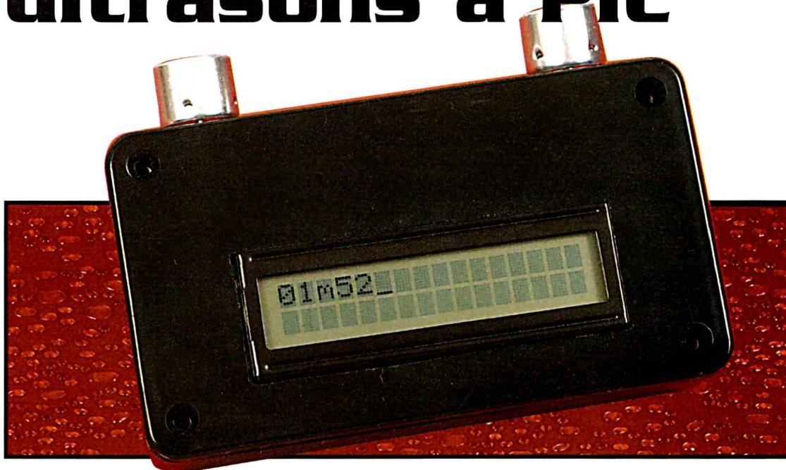
**Savoir mesurer une distance ou détecter des obstacles peuvent bientôt devenir bientôt des capacités indispensables pour vos futurs robots intelligents. Ce montage, articulé autour d'un microcontrôleur PIC 16F84 ou 16F628, décrit le fonctionnement complet d'un télémètre à ultrasons depuis la création des impulsions sonores jusqu'au calcul de la distance détectée en centimètres.**
