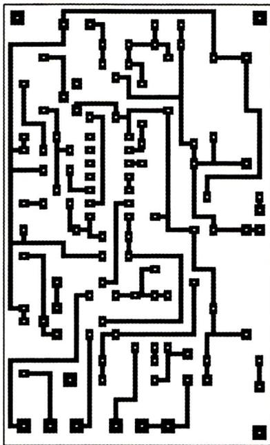
**3** Tracé du circuit imprimé
