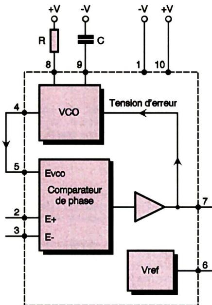
**2** Synoptique interne de la boucle à verrouillage de phase intégrée dans  $IC_1$
