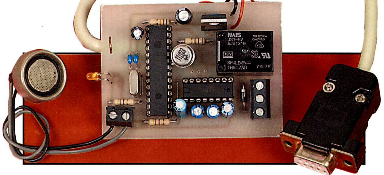
Les IBUTTON de DALLAS sont des badges de contrôle d'accès peu coûteux et faciles à gérer à partir d'un microcontrôleur. La gestion du protocole 1WIRE de DALLAS permet de communiquer avec l'ensemble de la gamme et, notamment, les capteurs de température (DS1820 et autres). Nous proposons d'étudier dans cet article une bibliothèque de communication pour ce protocole en réalisant une serrure électronique à clef DALLAS.
