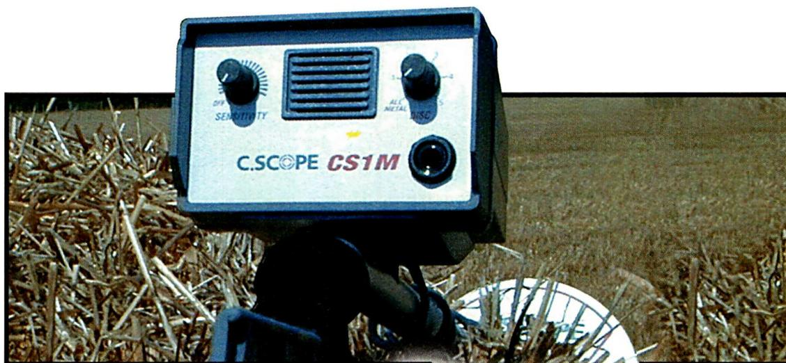
**Si l'on excepte les appareils à usage résolument professionnel que sont, par exemple, les magnétomètres et les radars souterrains, quasiment tous les détecteurs de métaux font appel au même principe de base : la modification des caractéristiques électriques d'un bobinage lorsqu'un corps métallique en est approché.**
