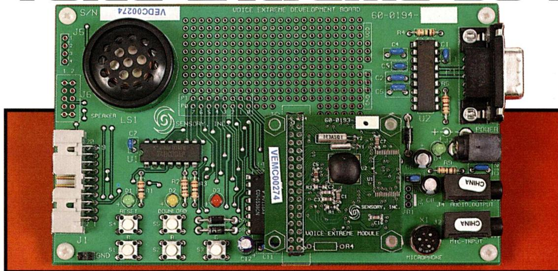
**Conçu par la société SENSORY, les modules de reconnaissance vocale Voice-extreme 364 permettent de réaliser des petits systèmes autonomes avec des fonctions vocales très avancées. Pour faciliter la conception et la mise au point des programmes pour les modules Voice-extreme 364, il existe maintenant un kit de développement que nous vous proposons de découvrir dans ces pages.**
