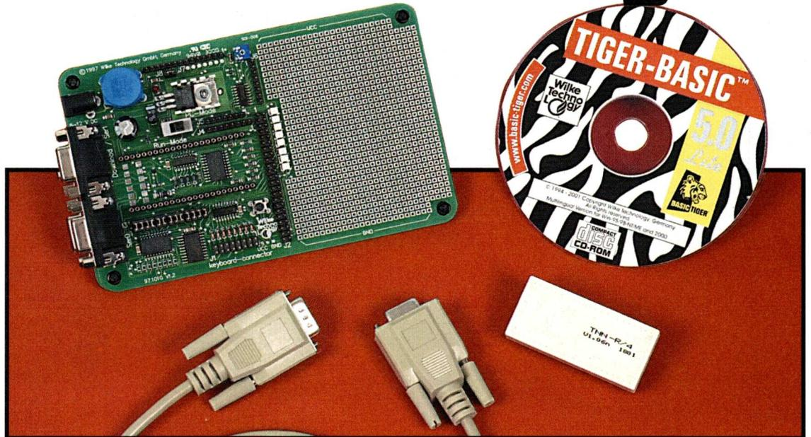
La mise en œuvre d'un système à microcontrôleur rebute souvent les amateurs en raison des langages de programmations qu'il faut maîtriser (langage C ou assembleur, la plupart du temps). Pourtant on peut surmonter ce handicap en programmant certains microcontrôleurs en langage BASIC. Le kit de développement Basic Tiger fait partie des outils de développement qui permettent de développer des applications puissantes dans le langage informatique le plus populaire.
