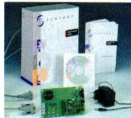
Le système "Extreme Voice" est un module de programmation associé à un ensemble de logiciel permettant de développer et programmer les modules VDR 364 de manière simple et aisée dans un langage évolué de type VE-C proche du ANSI-C (langage adapté aux techniques audio-numériques et aux extensions d'entrées/sorties diverses).
