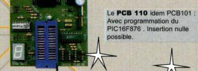
le **PCB110** idem PCB101 : Avec programmation du PIC16F876. Insertion nulle possible.
