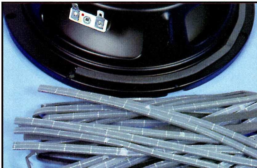
Un ruban d'étanchéité évite le passage de l'air et rattrape d'éventuels défauts de surface.
