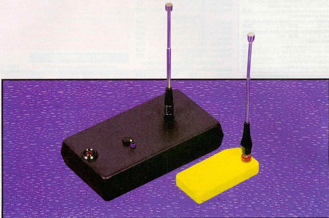
Ce montage, à caractère très domotique, vous évitera de sortir inutilement pour voir si le facteur a déposé du courrier dans votre boîte à lettres. En effet, dès que le couvercle de la boîte a été actionné par la dépose d'une lettre ou d'un journal, une signalisation lumineuse et sonore se déclenche. Grâce à la mise en œuvre d'une liaison radio, aucune installation problématique de fils ne sera nécessaire.
