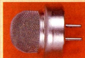
Au titre des composants intéressants, on peut remarquer un détecteur de gaz à 26F, ou bien un modulateur UHF PAL/SECAM qui transforme
