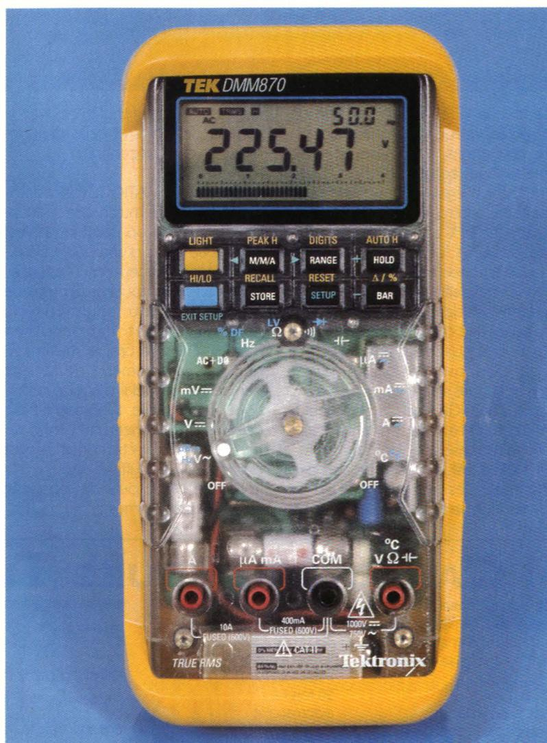
La touche HOLD permet d'activer et de désactiver le mode de maintien. Lorsque ce dernier est activé, l'appareil émet un signal sonore et l'indicateur affiche H.
