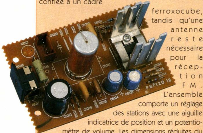
ferroxcube, tandis qu'une antenne reste nécessaire pour la réception F.M. L'ensemble comporte un réglage des stations avec une aiguille indicatrice de position et un potentiomètre de volume. Les dimensions réduites du module (100x65x30mm) permettent un logement facile. Un schéma de branchement complète l'ensemble; il suffit simplement de raccorder un haut-parleur et d'alimenter le tout sous 9V de tension. Prix 25 F.
