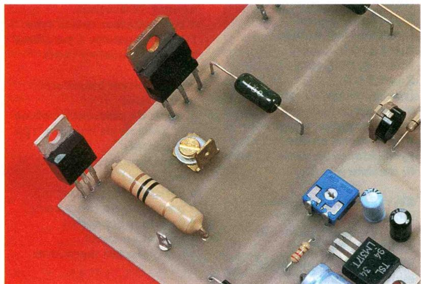
ra ce courant à 1A. Il faudra procéder de la même manière avec les cinq autres ajustables (RV<sub>2</sub>, RV<sub>3</sub>, RV<sub>4</sub>, RV<sub>5</sub> et RV<sub>6</sub>) en réglant le courant à la valeur souhaitée.
