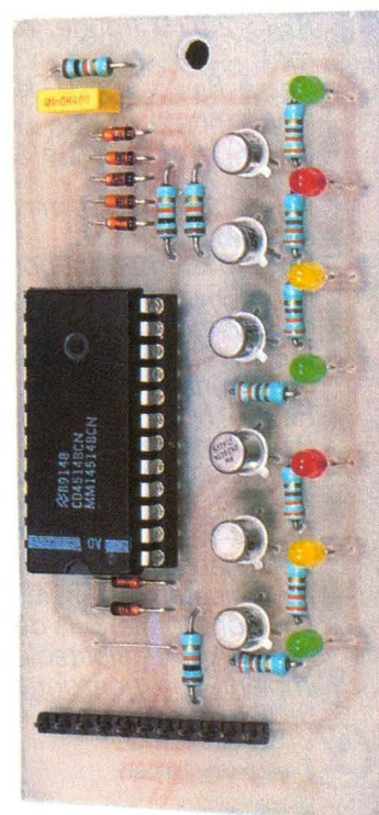
Photo 4. - Détail sur la carte d'affichage à DEL.
