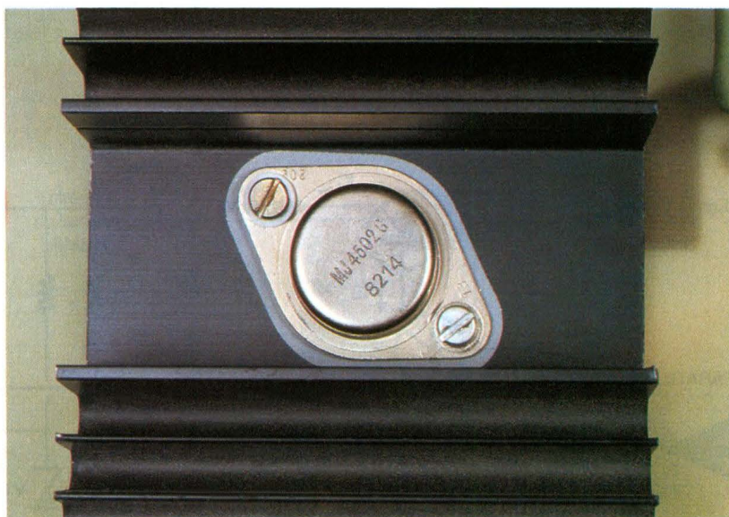
Photo 4. – Un gros radiateur permet une dissipation thermique efficace. ►
