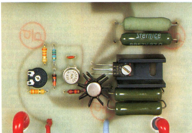
▲ Photo 2. – La résistance ajustable R_2 sert à fixer le seuil de commutation.
