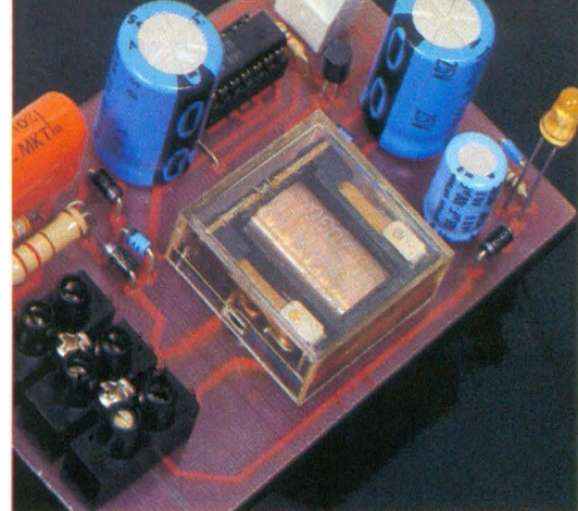
Photo 2. – Le relais met en service le convecteur selon les conditions établies à l'avance.
