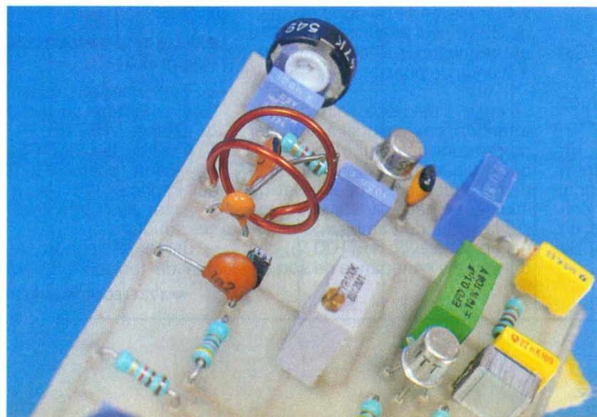
Photo 2. – La bobine du récepteur reste simple à réaliser.
