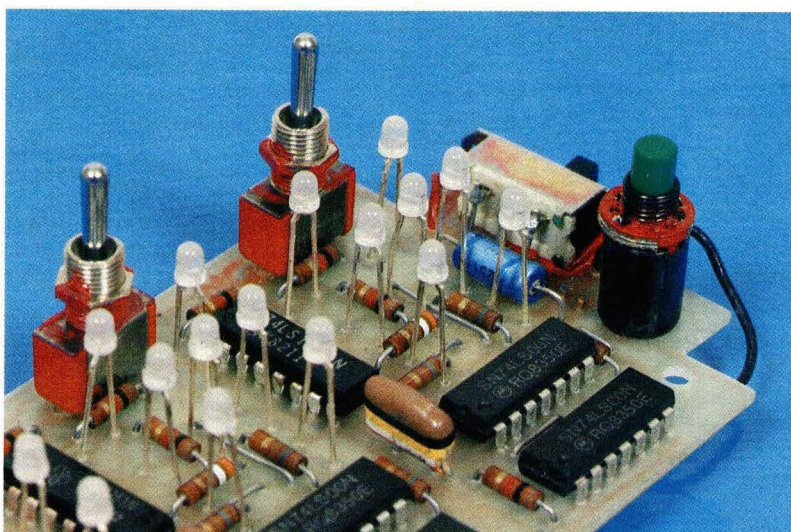
Photo 2. — Les DEL doivent toutes avoir la même hauteur pour passer dans les trous du boîtier.
