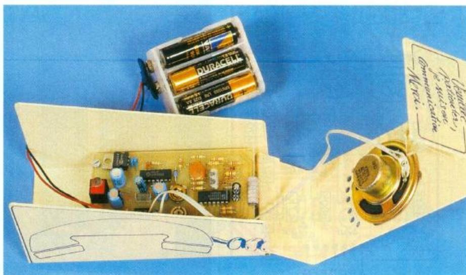
Une alimentation 5 V est réalisée à l'aide d'un régulateur. Pour être inséré dans le boîtier, le montage électronique comprend deux circuits imprimés reliés entre eux par un câble nappe. Le circuit du dessus comprend une touche interrupteur calibrée pour basculer sous un faible poids : c'est elle qui met le montage sous tension lorsque l'on pose le combiné sur le boîtier. Un inverseur sur le circuit imprimé du bas permet de sélectionner le message 1 ou 2.
