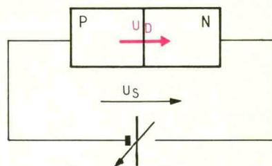
**11** La diode est branchée dans le sens bloquant.
