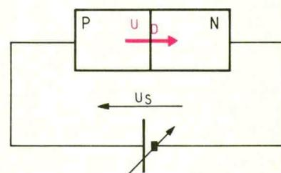
**10** La diode est branchée dans le sens passant.
