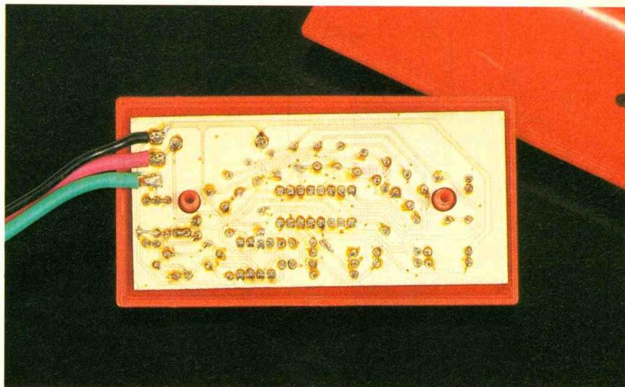
Photo 2. - Vue du circuit imprimé, côté cuivre.
