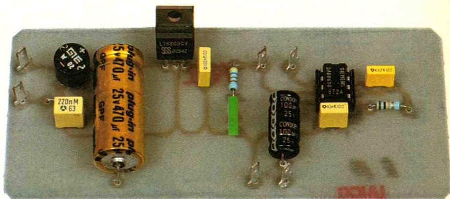
Le constructeur a intelligemment prévu l'utilisation du SAB600 sur site. En effet, l'entrée de déclenchement reliée au poussoir BP dispose d'un trigger interne, créant ainsi une immunité contre les déclenchements intempestifs du carillon, qui ne manqueraient pas de se produire en cas d'une liaison filaire importante entre la platine et le poussoir.
