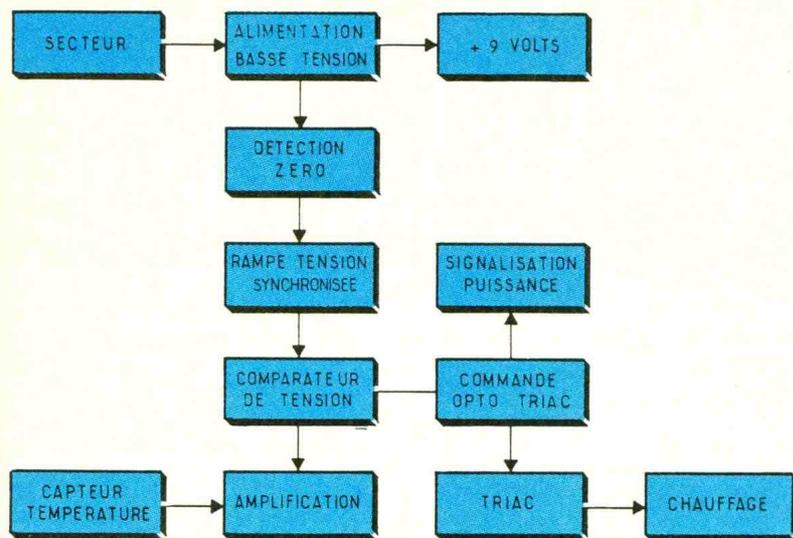
chauffage via un triac lorsque la sonde détecte une température supérieure à la valeur fixée. Ce type de montage représenté figure 1 comporte donc une sonde qui est placée dans la cuvette à l'opposé d'une résistance chauffante. Supposons maintenant que celle-ci soit alimentée normalement et que le bain ne soit pas mélangé, la chaleur rayonnée se propage donc lentement à tra-
