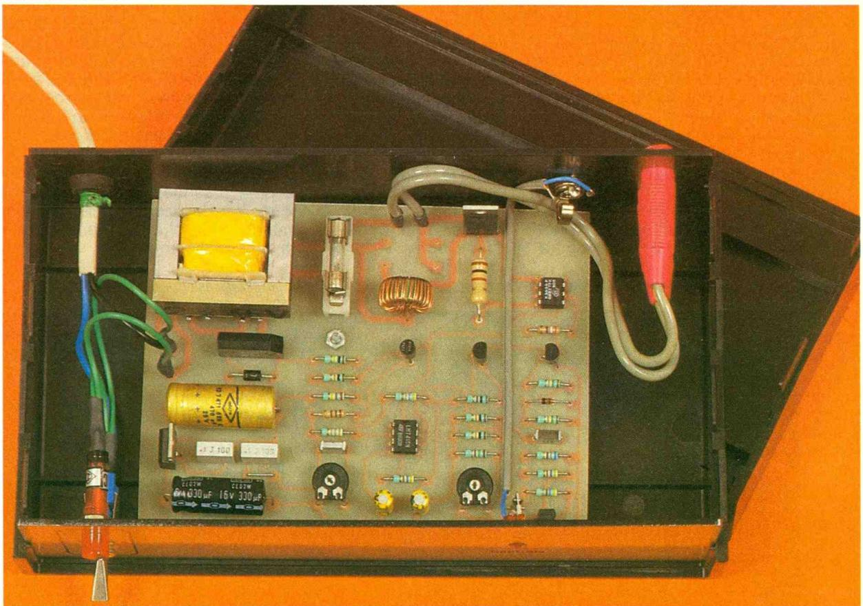
Initialement prévue pour le chauffage d'une cuvette de révélateur, cette maquette universelle convient également pour la gravure des circuits imprimés, pour le tirage photographique, mais aussi pour la régulation d'aquarium ou de tout système nécessitant une température constante. Nous verrons en fin d'article d'autres domaines d'application.
