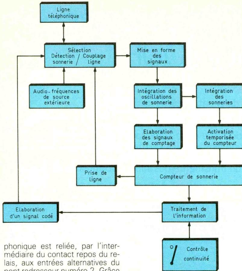
phonique est reliée, par l'intermédiaire du contact repos du relais, aux entrées alternatives du pont redresseur numéro 2. Grâce à ce pont redresseur, il n'est pas besoin de tenir compte de la polarité de la ligne. Les signaux de sonnerie suivent une loi de variation sinusoïdale dont une fraction du potentiel est disponible au point commun de  $R_3$  et de l'ajustable  $A_1$ . Ils sont acheminés sur la base du transistor  $T_2$  par l'intermédiaire de  $C_4$ .
