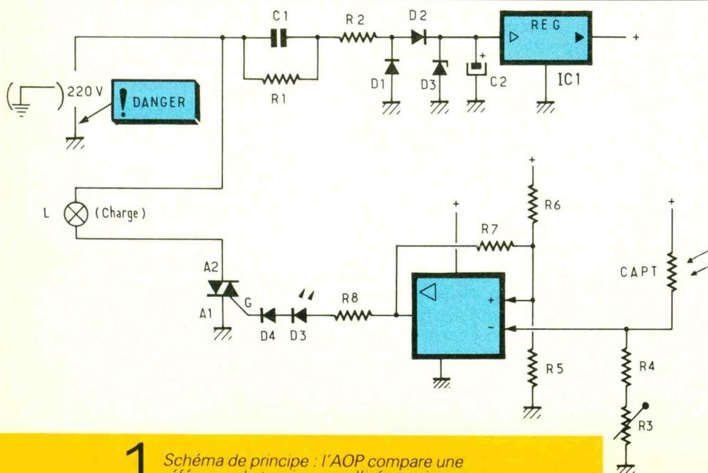
1 Schéma de principe : l'AOP compare une référence de tension avec l'information provenant de la photorésistance.
