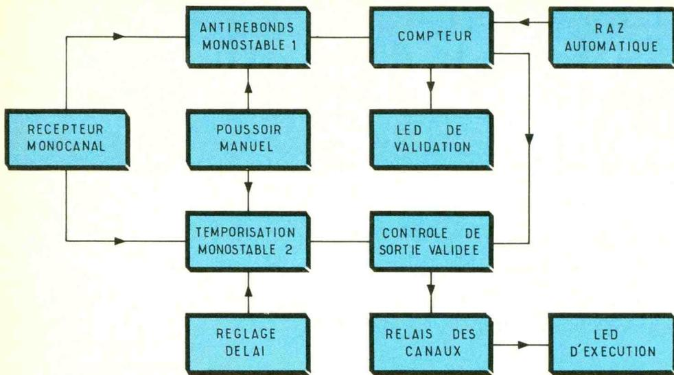
Bien entendu, on pourra à l'aide d'un bouton-poussoir local suppléer l'émetteur, ne serait-ce que si celui-ci est égaré, en panne ou à court de piles. L'alimentation de notre module est confiée au secteur, car il est destiné à être relié à des récepteurs alimentés eux aussi le plus souvent sur le réseau EDF. Après l'incontournable transformateur abaisseur, on
