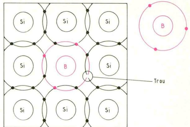
b) Dopage avec des atomes ayant 3 électrons de valence (bore, gallium, indium). Le dopage se réalise exactement comme précédemment, mais maintenant, on obtient un semi-conducteur extrinsèque possédant, lui, un surplus de trous (fig. 4). Le résultat est un semi-conducteur de type P (positif puisque déficitaire en électrons).
