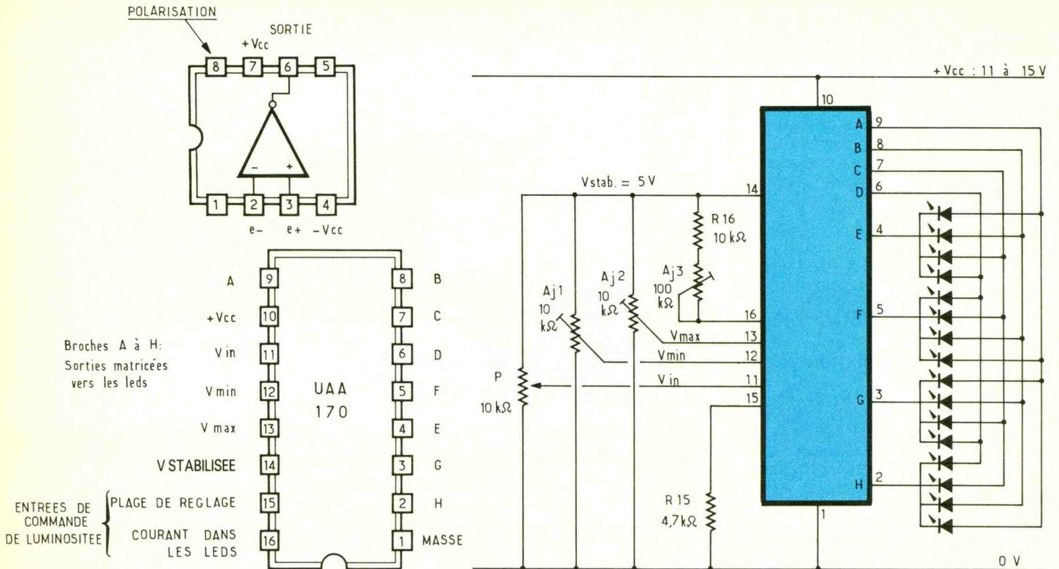
± 5 % près, l'ajustable devra « couvrir » une plage d'au moins ± 5 % de la tension Vcc, soit 125 mV. Or le réglage doit se faire au millivolt près, vu l'amplification qui suit, soit une manœuvre au 1/100<sup>e</sup> de tour, ce qui n'est guère pratique !
