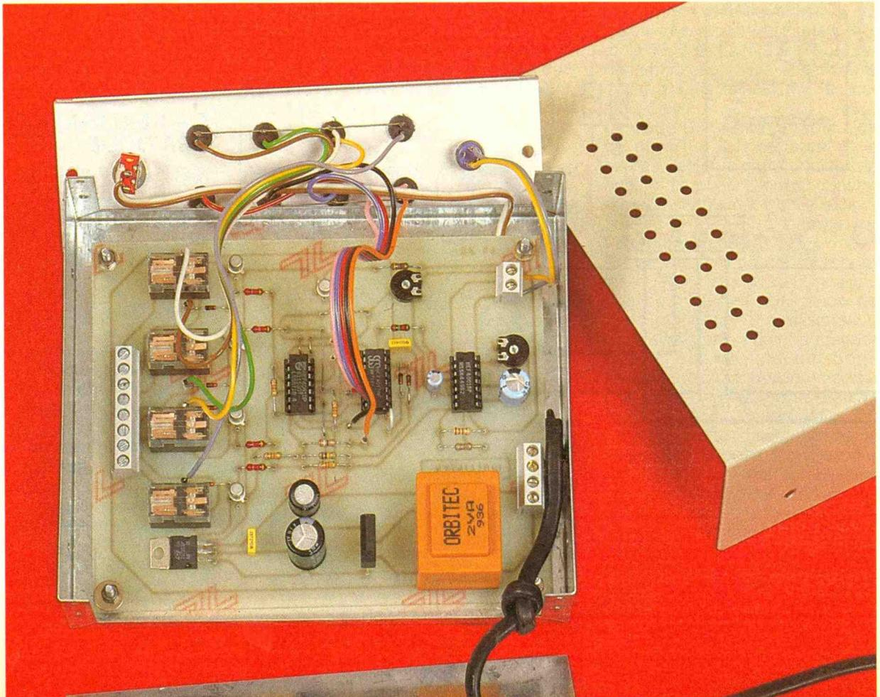
rieux contrôle, il est temps de procéder aux essais de la maquette. On teste tout d'abord le fonctionnement de la section alimentation qui doit délivrer une tension proche de 12 V. On doit la retrouver sur les trois supports des circuits intégrés.
