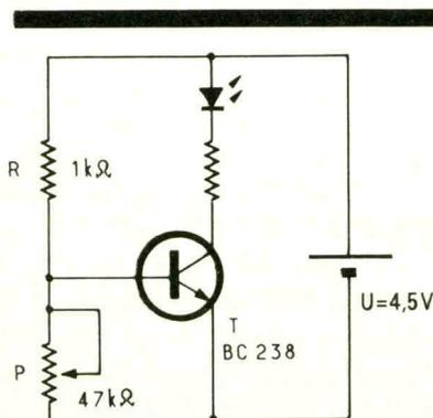
**5** Une élévation de la température accentue la conductibilité du transistor.
