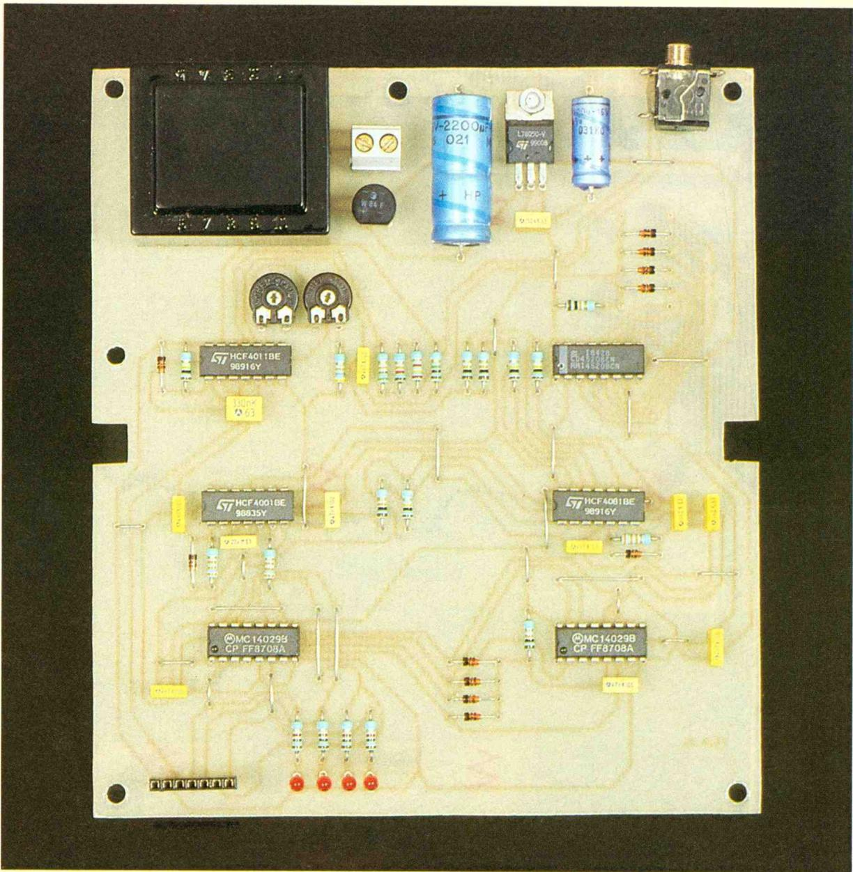
Photo 3. – Ce circuit imprimé reçoit la partie alimentation ainsi que la chaîne de mesure de la température.
