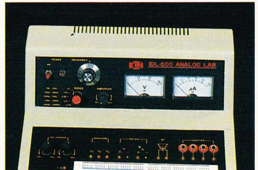
Photo 3. — Aperçu des deux galvanomètres mesurant la tension et le courant (V et μA).
