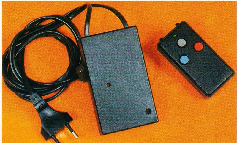
commutation « marche-arrêt » est assurée par un triac capable de fonctionner aussi bien avec des charges résistives qu'inductives.
