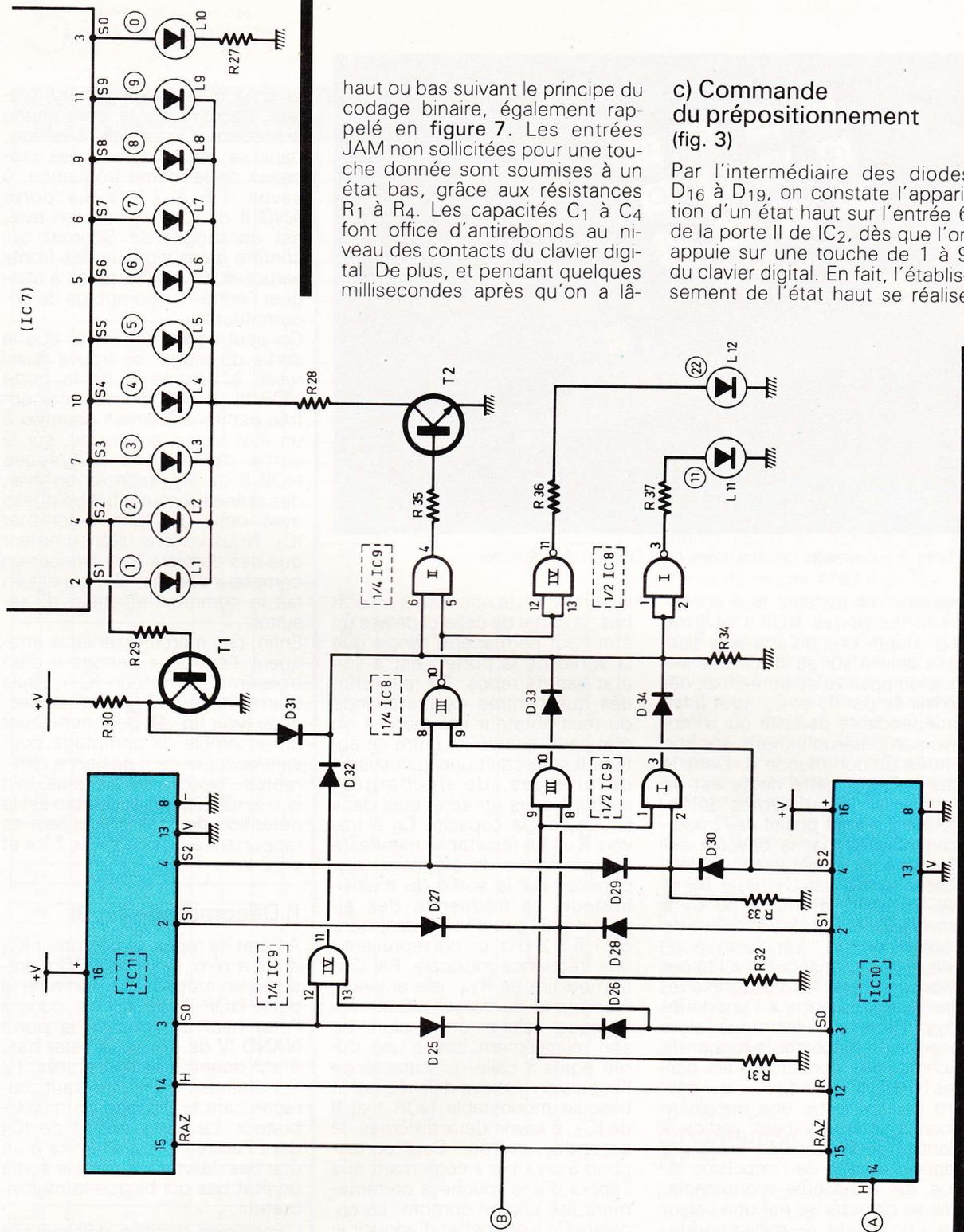
haut ou bas suivant le principe du codage binaire, également rappelé en **figure 7**. Les entrées JAM non sollicitées pour une touche donnée sont soumises à un état bas, grâce aux résistances R<sub>1</sub> à R<sub>4</sub>. Les capacités C<sub>1</sub> à C<sub>4</sub> font office d'antirebonds au niveau des contacts du clavier digital. De plus, et pendant quelques millisecondes après qu'on a lâ-
