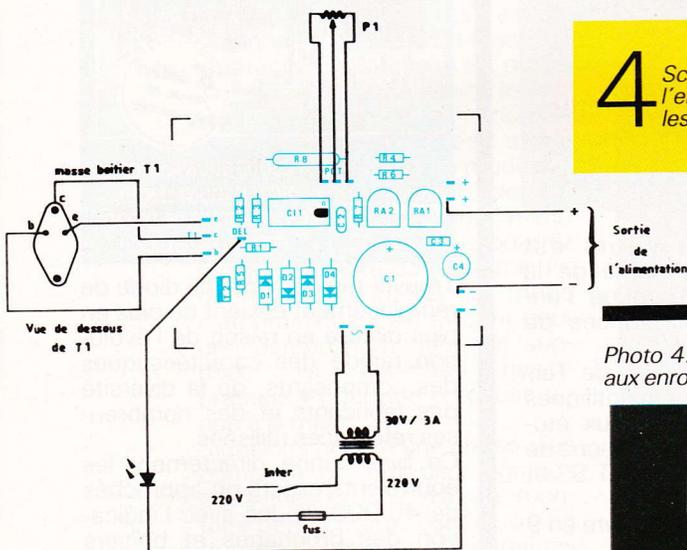
**4** Schéma de câblage de l'ensemble n'incorporant pas les appareils de mesure.
