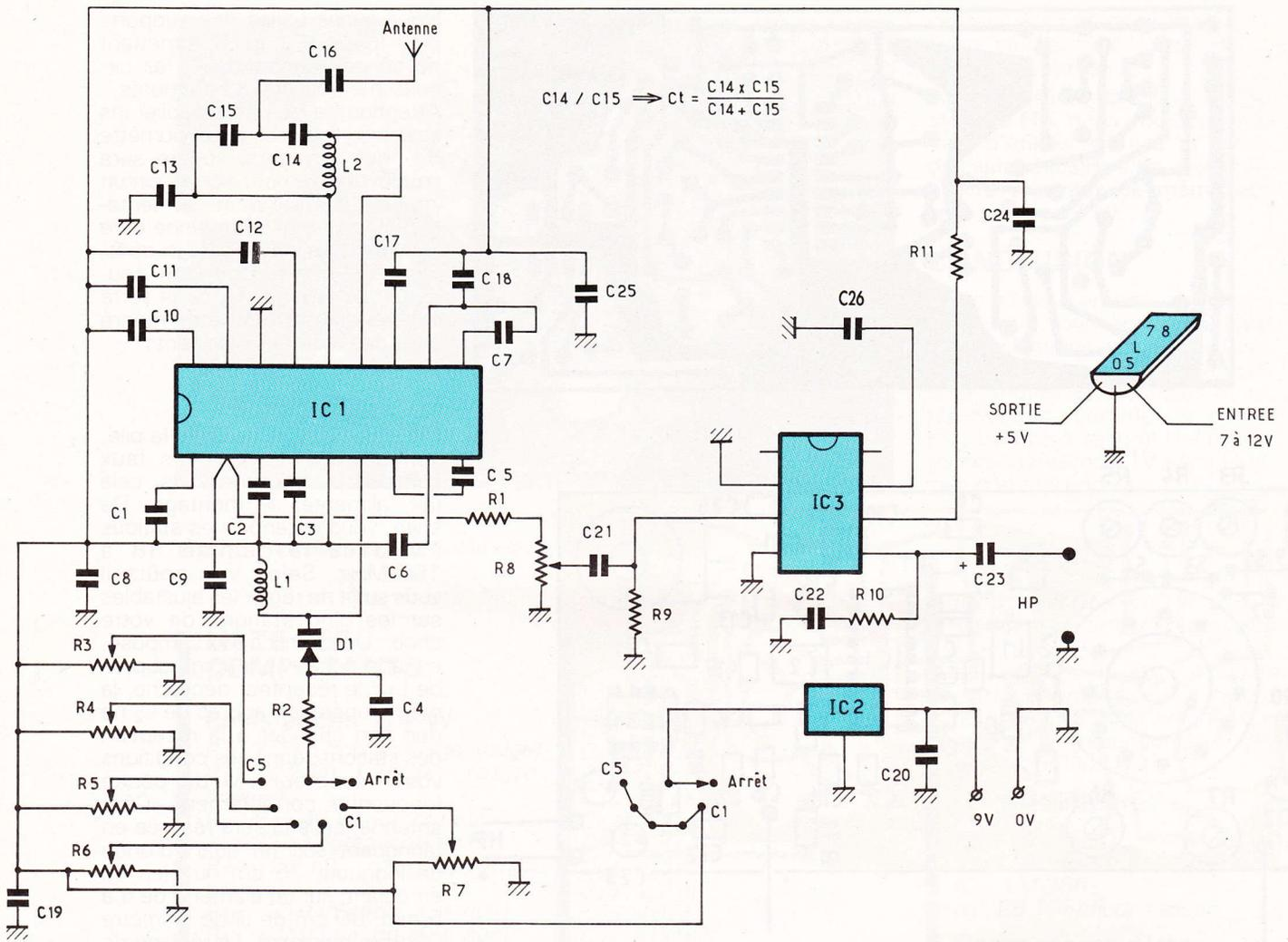
dre une tension BF dont l'amplitude est fonction du déphasage. Cette tension BF est récupérée sur la broche n° 2 à un niveau de 70 mV crête à crête (c/c). Le condensateur C<sub>9</sub> effectue la dé-
