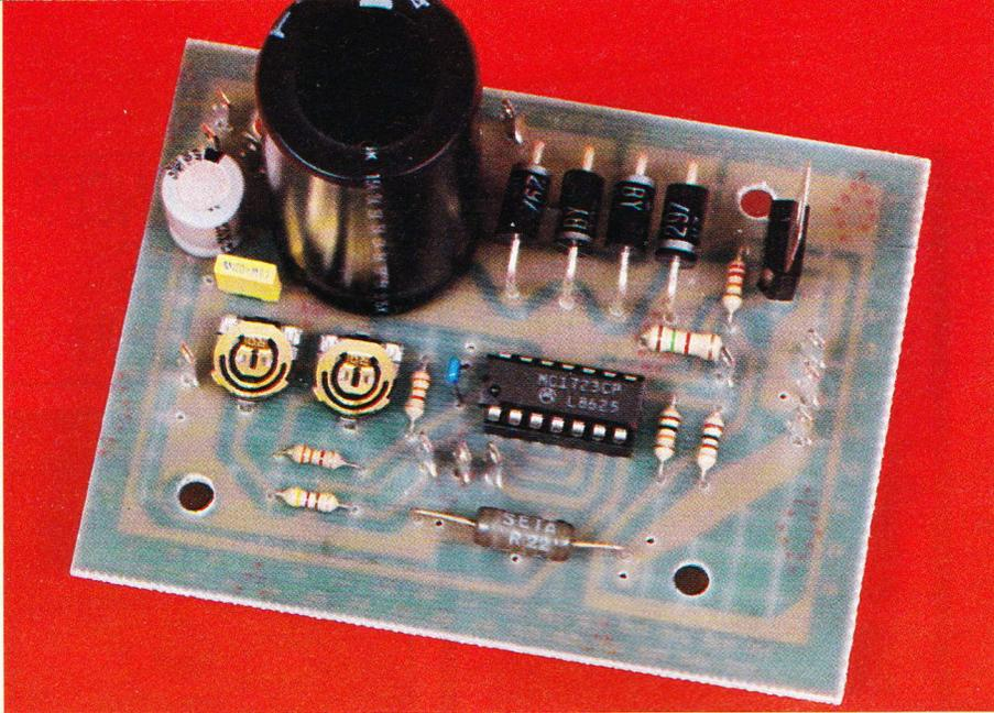
Photo 3. – La platine nue, incorporant le condensateur chimique vertical de filtrage.
