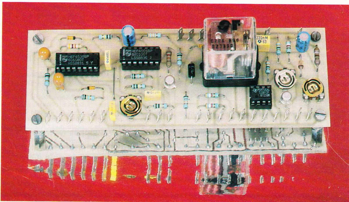
Photo 2. – La platine principale : l'ensemble des connexions avec l'extérieur s'effectuera à l'aide de cosses fast-on.
