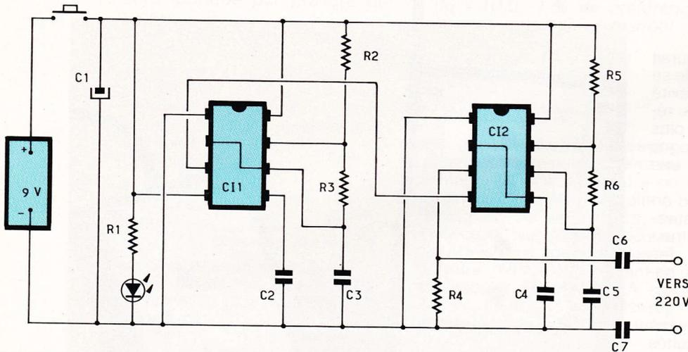
nant sur 100 kHz. Le signal résultant est couplé au secteur à travers deux condensateurs d'isolement.
