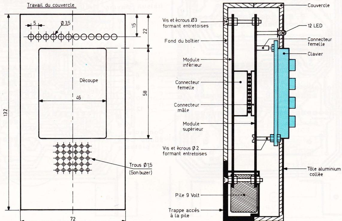
**10** Découpe et perçages à réaliser sur le couvercle supérieur du coffret/installation de la maquette à l'intérieur d'un coffret Teko.
