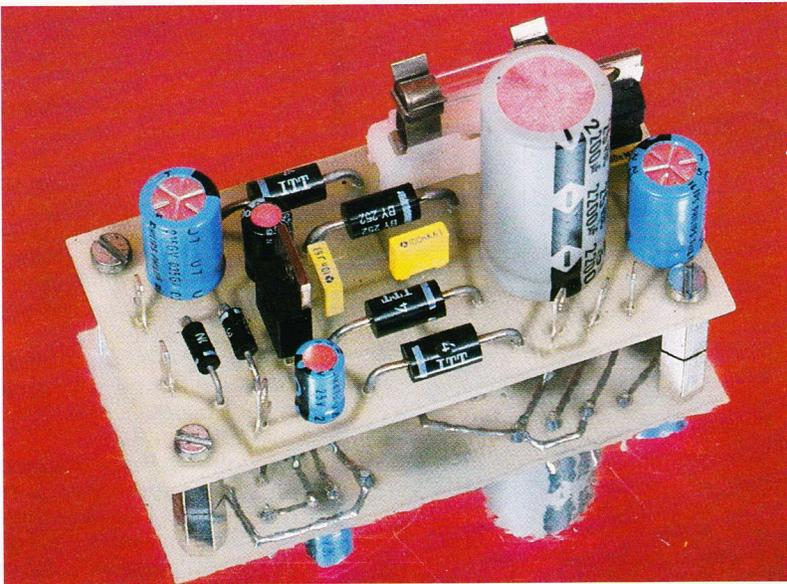
Photo 3. – L'alimentation comportant en gris le condensateur radial de filtrage, C11.
