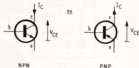
1 Caractéristique  $I_c = f(V_{ce})$  d'un transistor/repérage de paramètres sur des transistors NPN et PNP.
