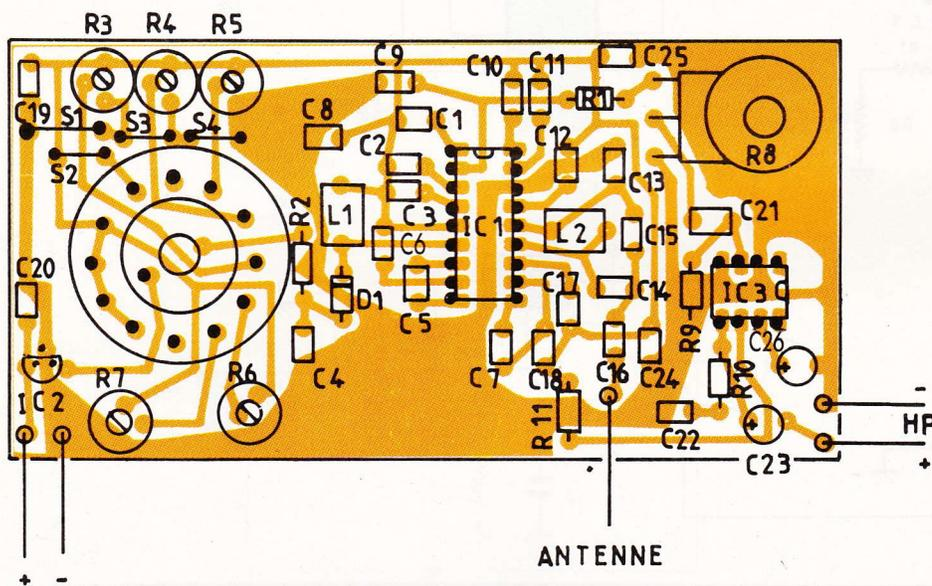
Photo 2. - Le montage utilise uniquement deux bobines à air, très facilement réalisables.
