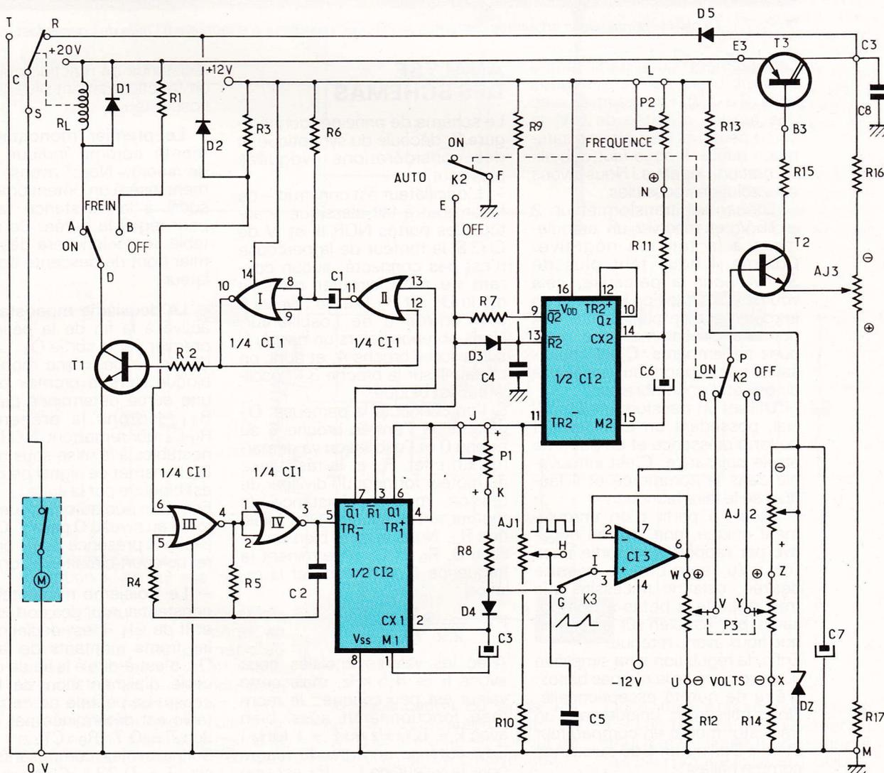
**3** Schéma de principe du variateur. La régulation simplifiée au maximum utilise uniquement un transistor monté en comparateur et un Darlington de puissance.
