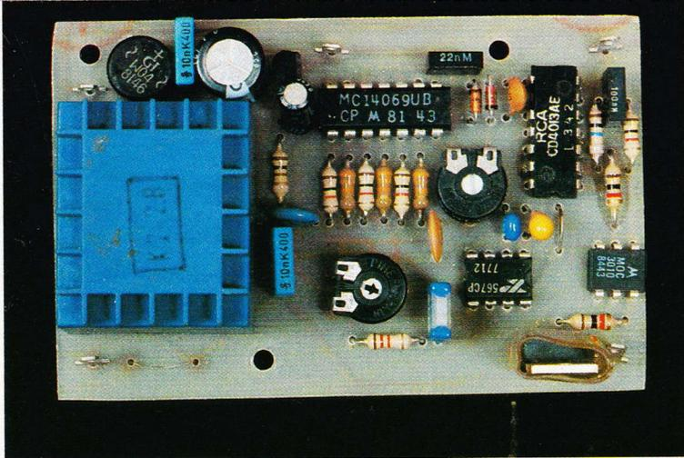
Le module du récepteur : on aperçoit les deux ajustables de réglage P<sub>1</sub> et P<sub>2</sub>.
