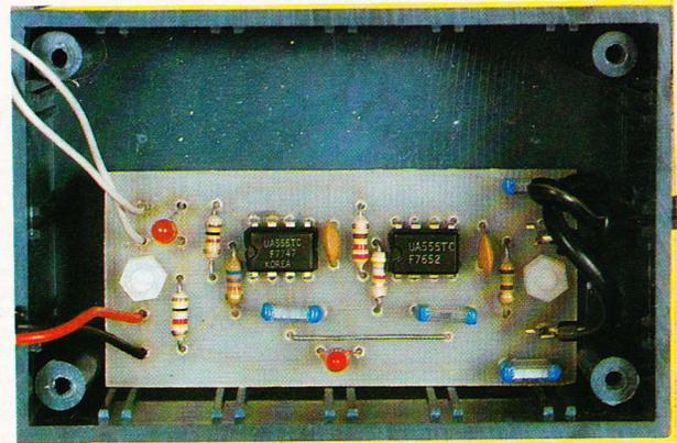
La platine de l'émetteur incorporée dans un boîtier Teko.
