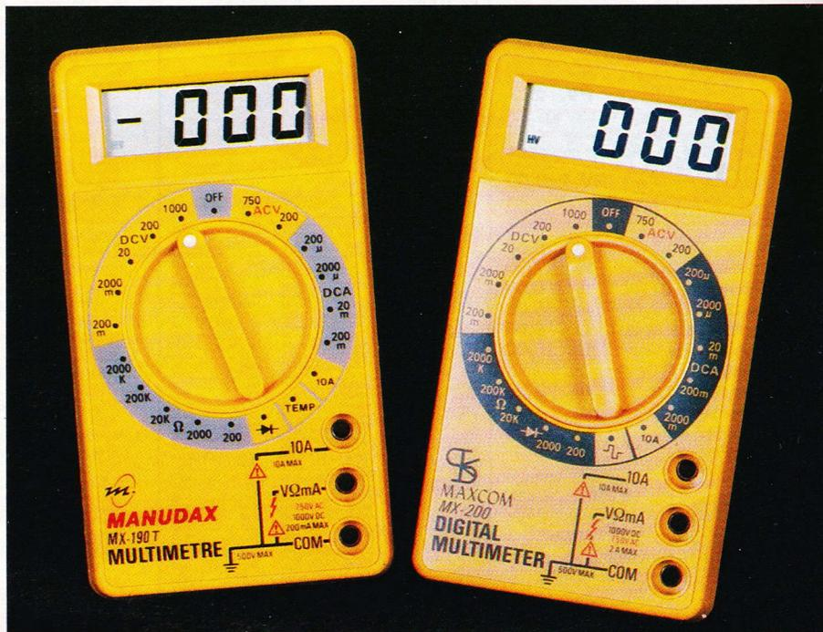
vice (arrêt). L'utilisateur connectera ses cordons entre les bornes « V- $\Omega$ -mA » et « COM » pour l'ensemble des mesures réalisées, excepté pour les mesures d'intensités ne dépassant pas 10 A où l'on utilisera la borne repérée « 10 A » (ainsi que « COM »).
