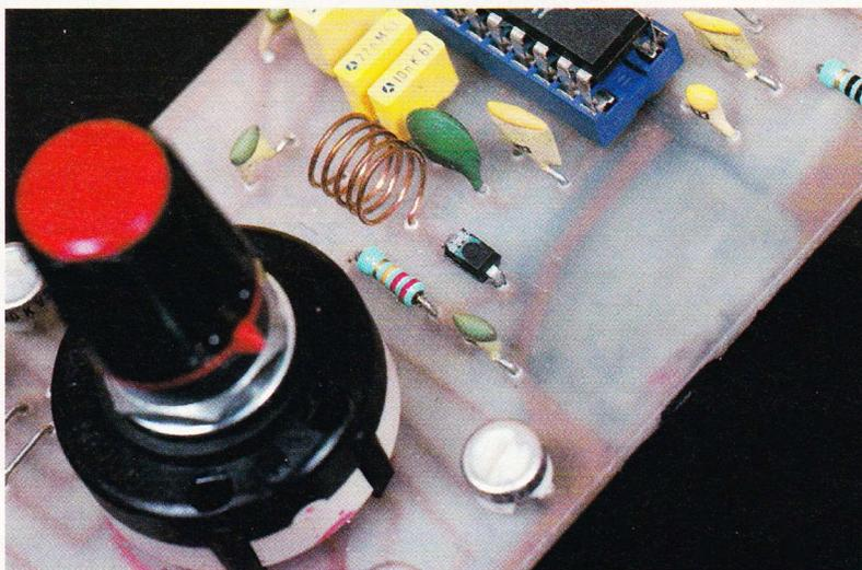
Photo 3. – La diode Varicap située à la droite du bobinage.
