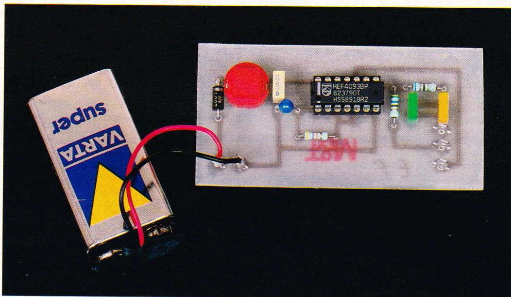
N'utilisant ni galvanomètre ni affichage digital, il indique instantanément le type et l'état du semi-conducteur testé.
