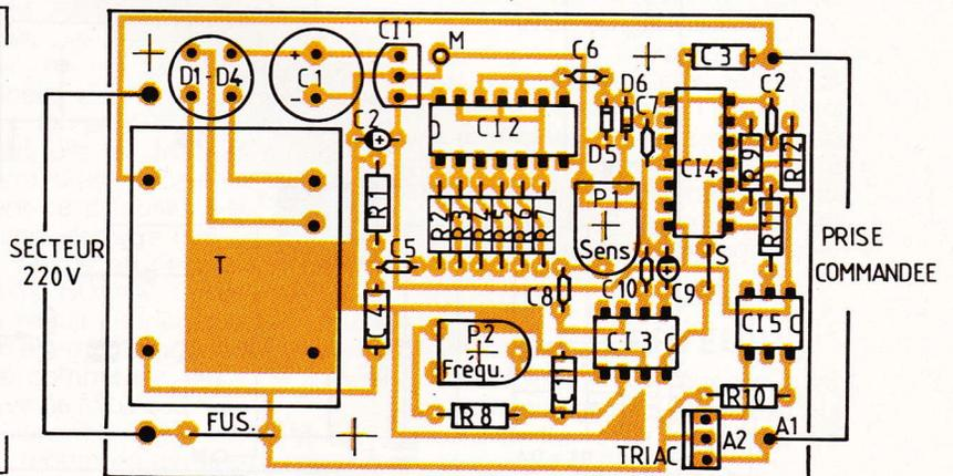
5-6 Les circuits imprimés à l'échelle 1 : Attention au tracé si le transformateur utilisé ne correspond pas à celui présenté.
