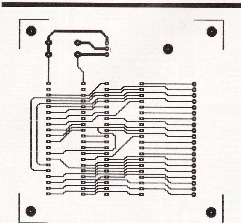
**1** Un exemple de sortie (toujours à l'échelle 1) sur imprimante. CIAO peut aussi travailler avec des traceurs au standard HPG.
