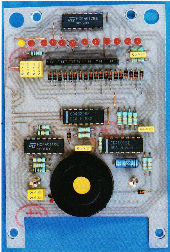
Photo 2. – Lors de l'appui sur une touche du clavier, le buzzer piézo-électrique fournit un bip de rappel.
