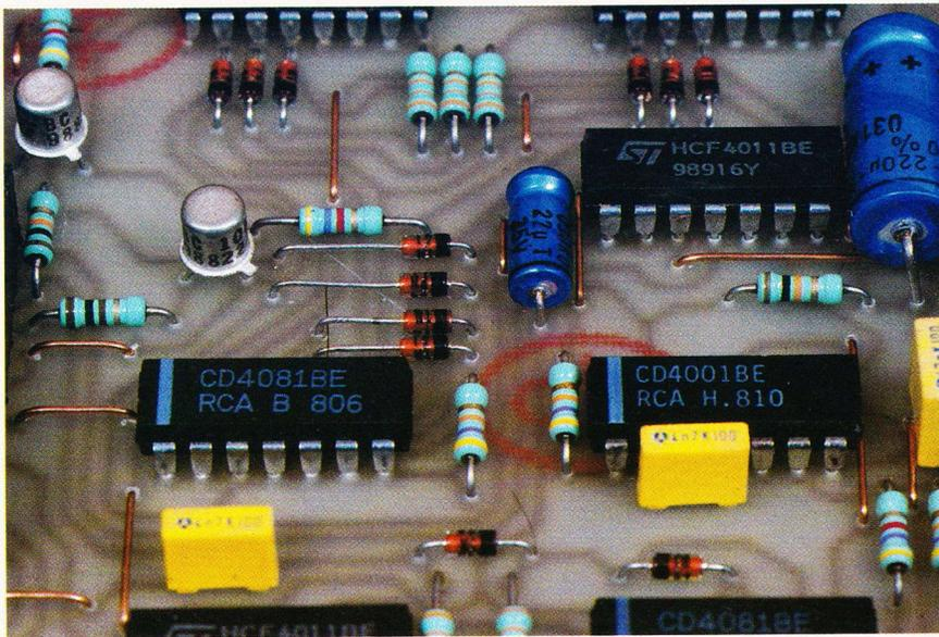
Photo 5. – Les circuits intégrés retenus appartiennent à la série CMOS 4000.
