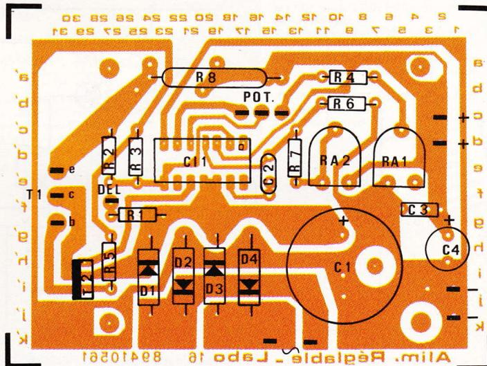
2-3 Circuit imprimé et implantation de LABO 16E : un vernis épargne recouvre côté cuivre, l'époxy évitant ainsi lors de l'opération de soudage les courts-circuits accidentels.
