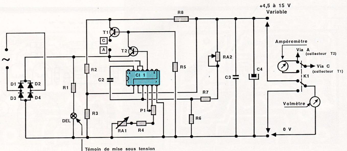
1 Schéma de principe : le kit utilise un 723 pour piloter l'alimentation. L'étage de sortie repose sur un transistor de puissance NPN référencé 2N3055.
