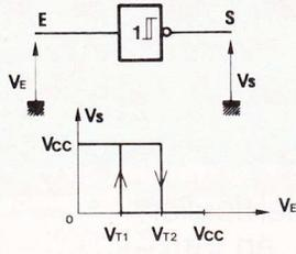
(b)  $V_{T1} \approx 1,9 \cdot V_{CC}$  (CD 40106),  $1,5 \cdot V_{CC}$  (74C14),
