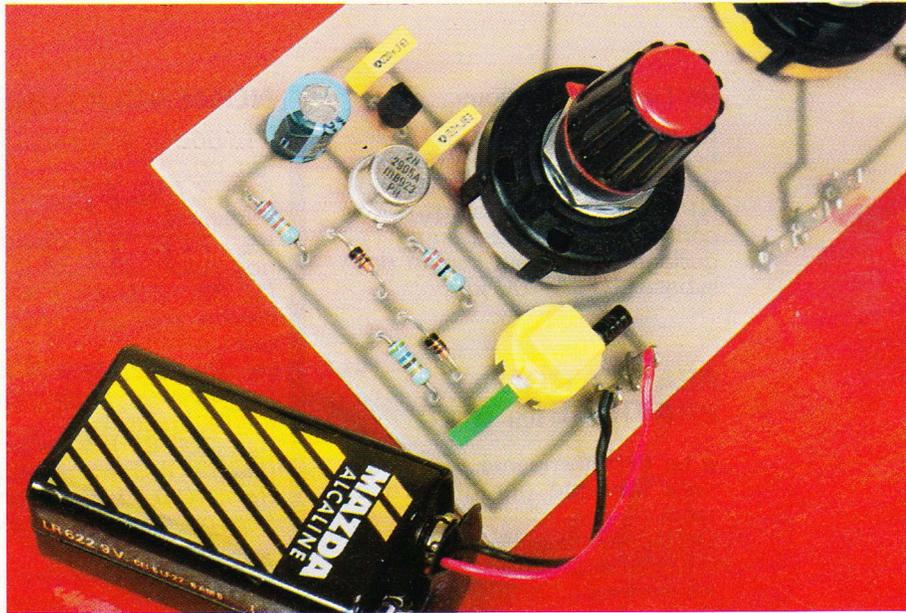
Photo 2. - Vue du poussoir Isostat jaune et du rotacteur, directement soudés sur le circuit imprimé.
