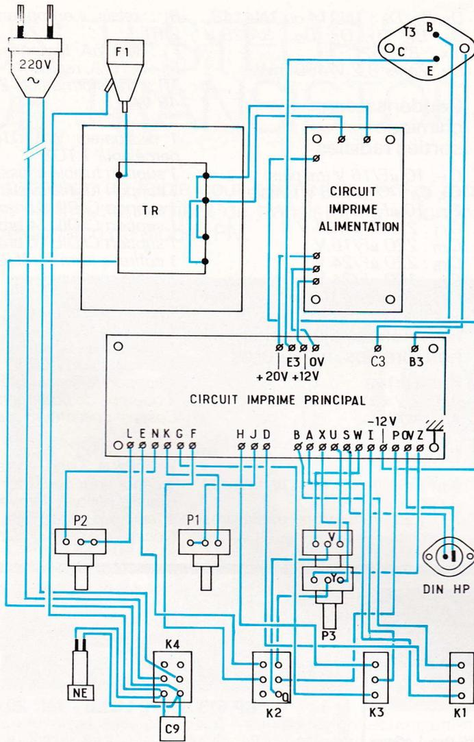
En coupant le mode « auto » par K<sub>2</sub>, régler maintenant Aj<sub>2</sub> pour obtenir une tension continue de 14 V elle aussi.
