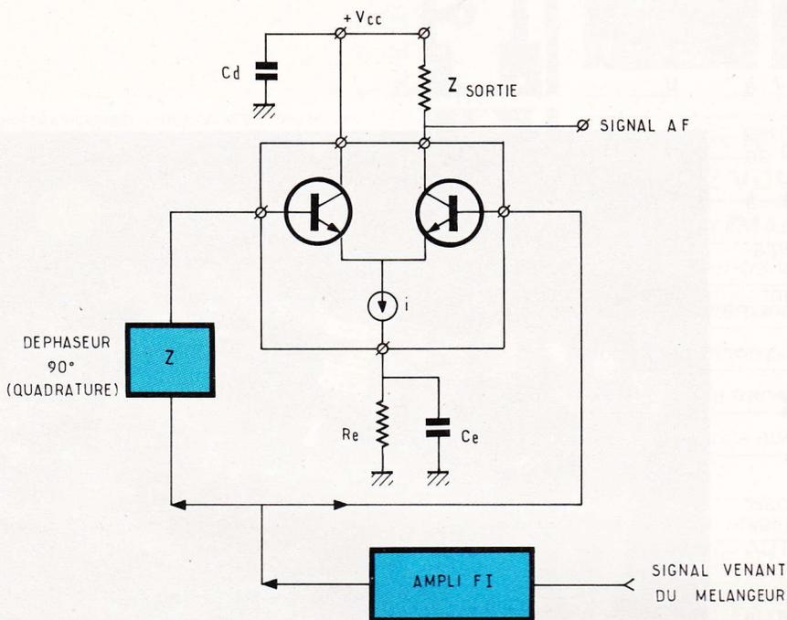
intégrateur de la tension BF. La tension qui en sort asservit en fréquence l'oscillateur local du TDA 7000. Avec une fréquence intermédiaire de 70 kHz et une excursion de  $\pm 75$  kHz, il était obligatoire de faire suivre l'oscillateur local au rythme de la modulation.
