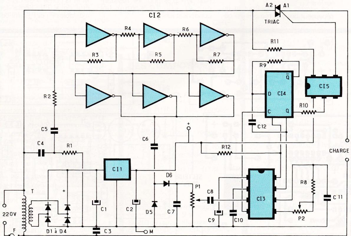
faire qu'à travers un système d'isolation optoélectronique. Pour cela nous avons choisi un photocoupleur à triac MOC 3010 ou 3020 robuste et peu exigeant en puissance de commande.
