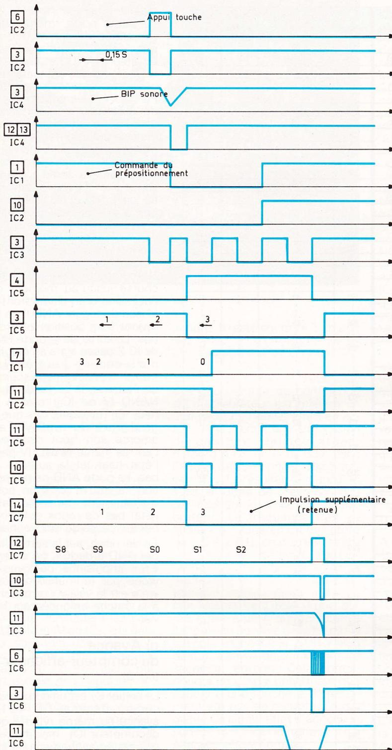
données au chapitre consacré au principe... En effet, la nouvelle position devrait être dans ce cas 3 ( $7 + 5 = 12 \Rightarrow 1 + 2 = 3$ ) pour répondre à la règle de réduction préalablement énoncée. En fait, il convient de détecter le passage de la valeur « 0 » sur IC7 et de rajouter une impulsion sur
