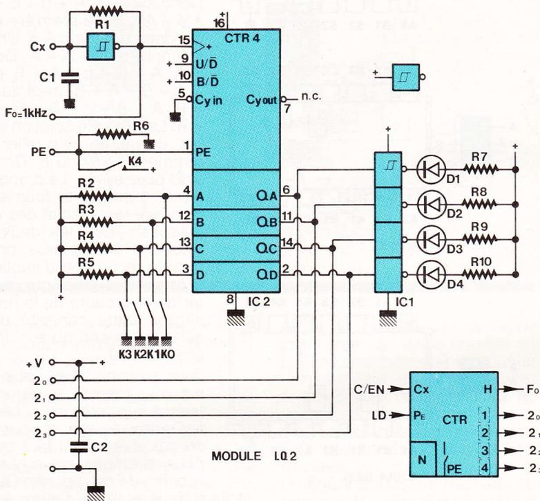
Hormis les portes ET-NON, les seules portes à seuils (« trigger ») sont les portes NON. Il existe deux références, 40106B ou 74C14, et souvent les circuits sont marqués avec ces deux références car totalement compatibles. Ils intègrent six portes NON « trigger ».
