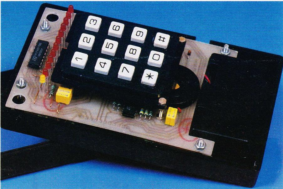
Photo 3. — Le clavier minikéy utilisé pour l'entrée des données.
