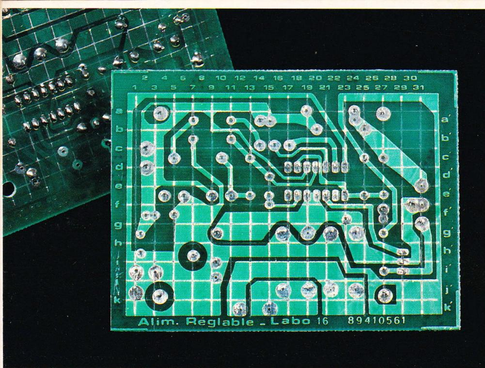
Photo 2. - Vue de l'alimentation stabilisée variable, côté époxy cuivrée vernis.
