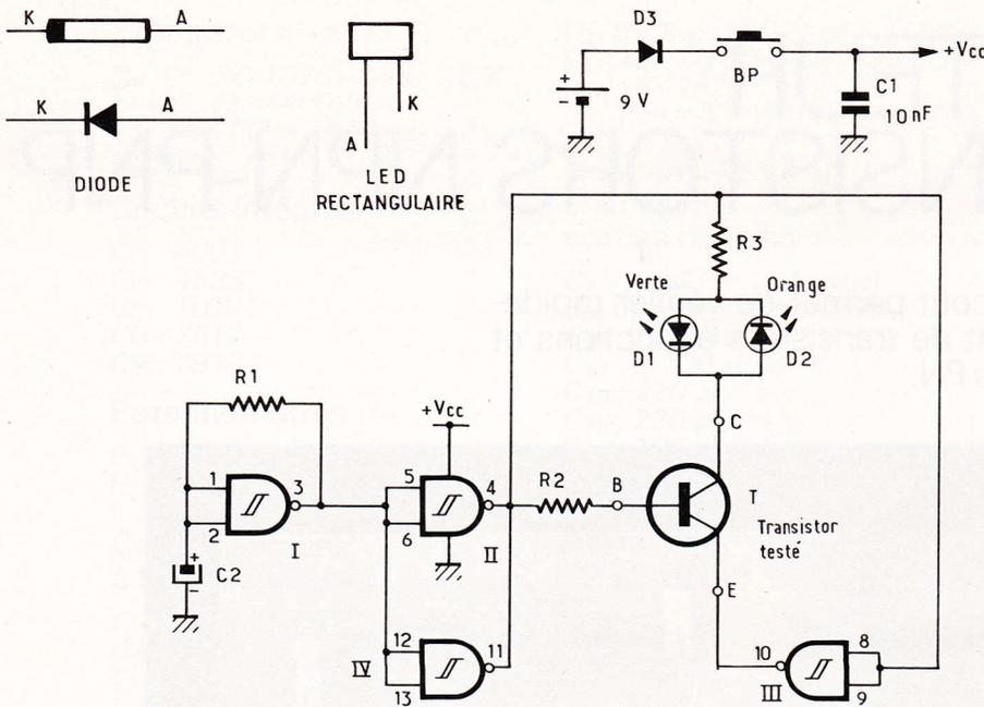
et IV bufférisent et complètent l'astable puis commandent R2, la résistance de polarisation du transistor testé. Ce signal est à nouveau complété par l'opérateur III, monté en inverseur.
