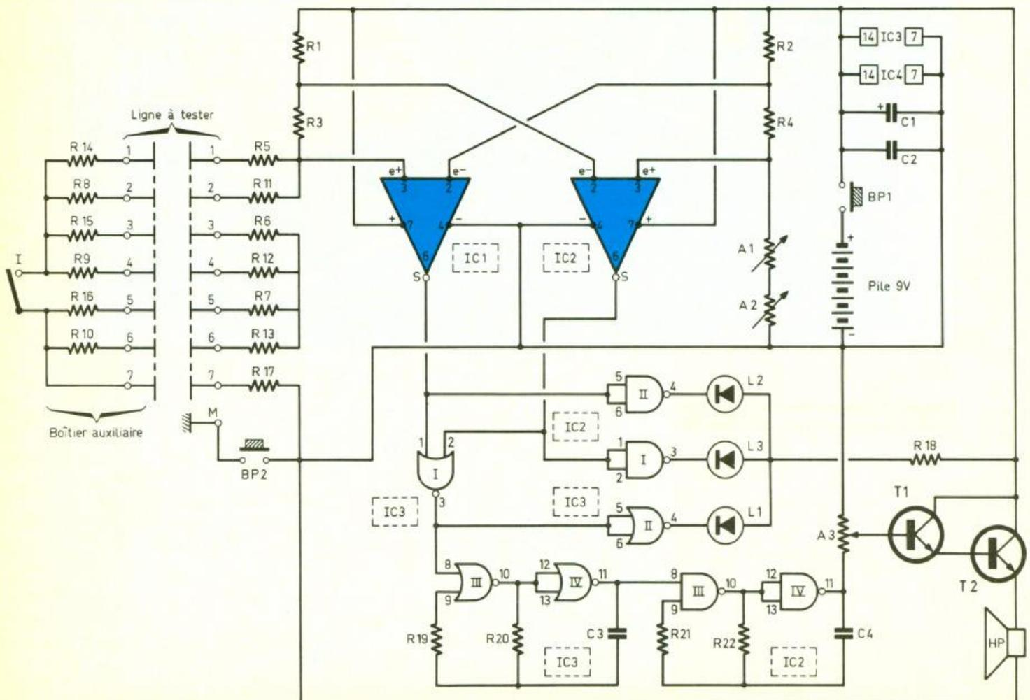
1 Ce schéma de principe autorise le contrôle simultané d'un nombre de conducteurs pouvant aller jusqu'à sept. On retrouve 741, 4001 et 4011.
