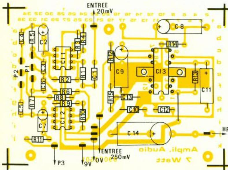
Photo 3. – Aspect du circuit imprimé non percé.
