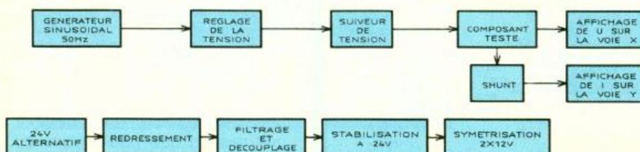
1 Synoptique : le composant testé, soumis à une tension sinusoïdale d'amplitude réglable, voit son courant limité par une résistance shunt.
