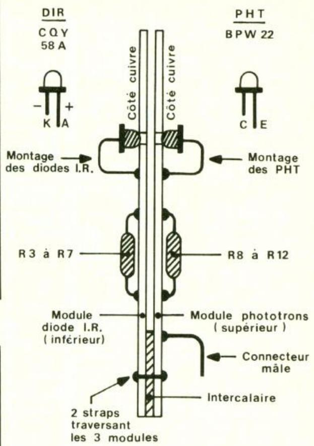
**7** Les composants du module supérieur et du module inférieur du lecteur optique seront soudés côté cuivre. Les pistes cuivrées sont ici représentées en rouge.
