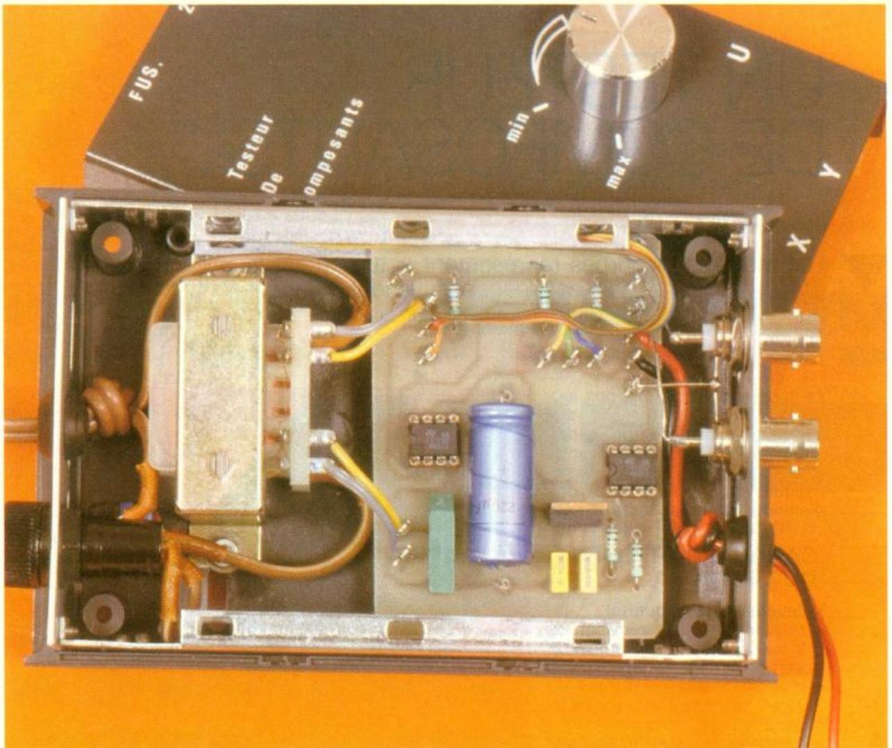
Photo 2. – Aperçu du montage introduit à l'intérieur d'un coffret « Retex ».
