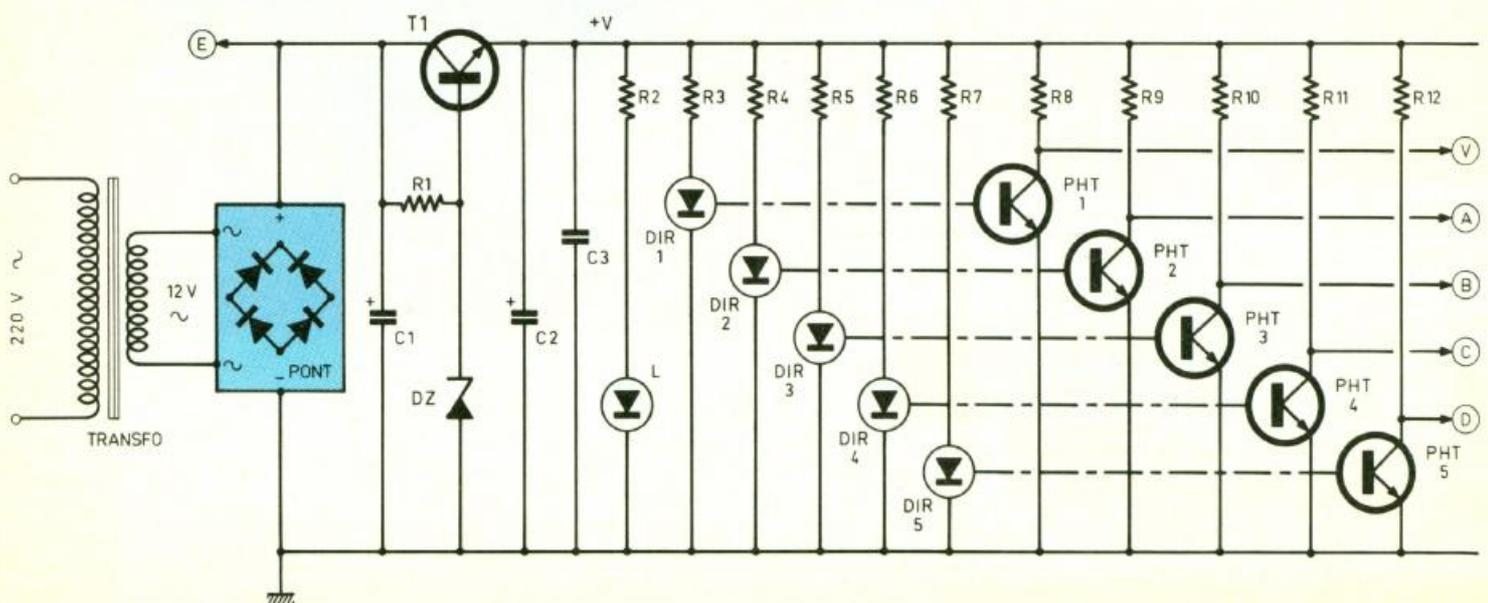
2 *Le schéma de principe de la section alimentation et lecture fait appel à des phototransistors.*
