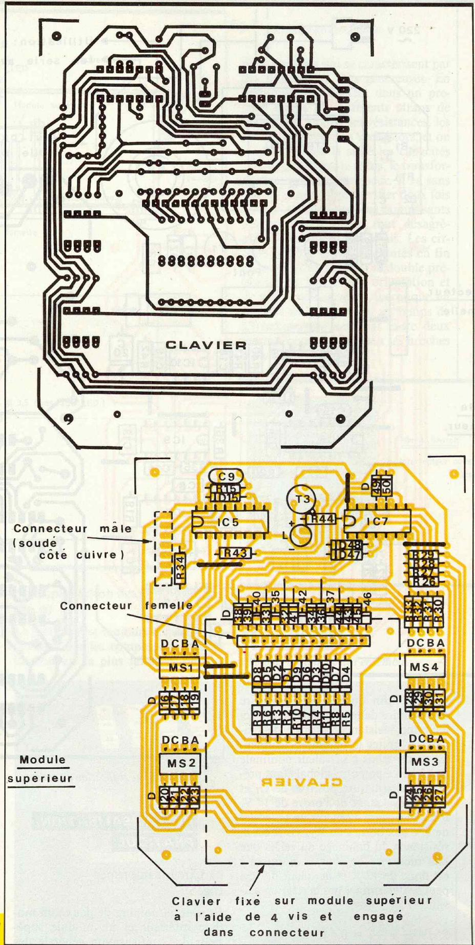
Détails de réalisation à l'échelle de la partie clavier.
