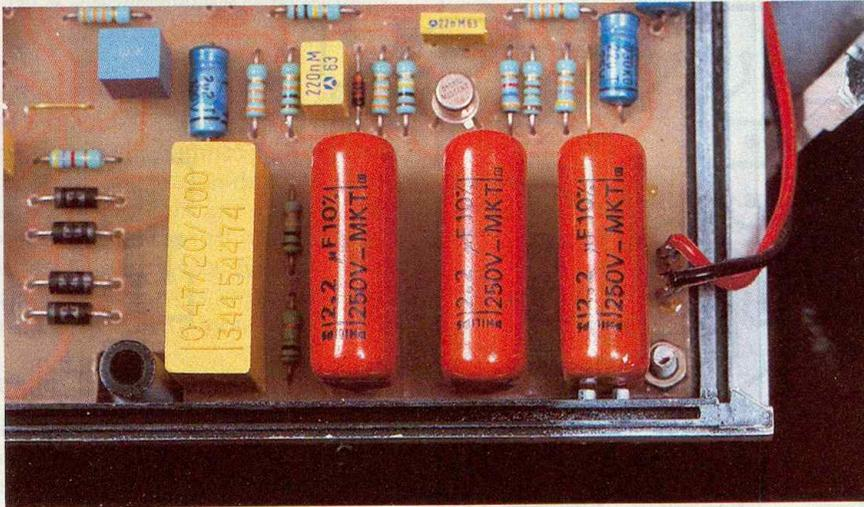
Photo 4. La batterie de condensateurs.
