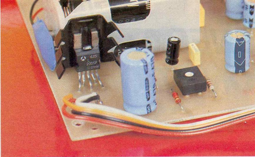
Photo 4. - Gros plan sur le régulateur L 200.
