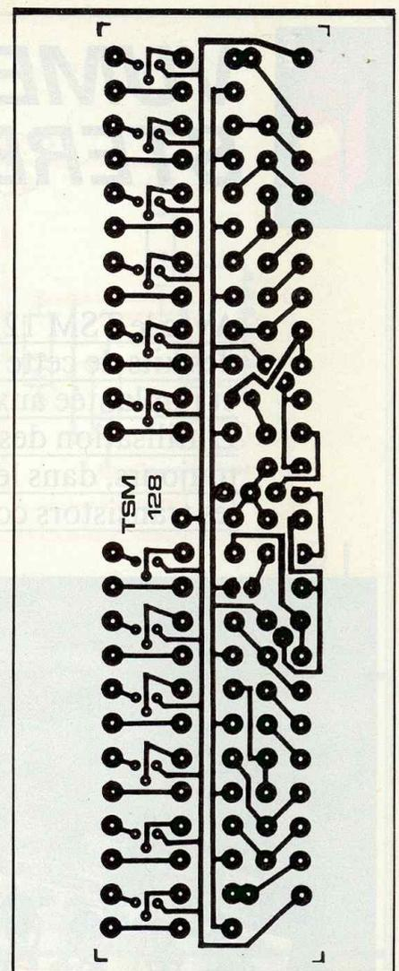
Tracé du circuit imprimé à l'échelle.
