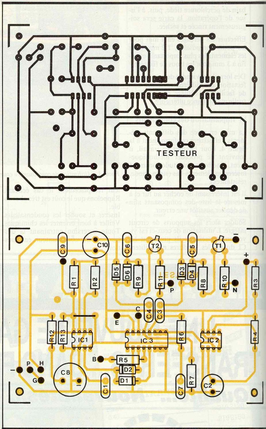
Fig. 3 et 4 Détails de réalisation à l'échelle.
