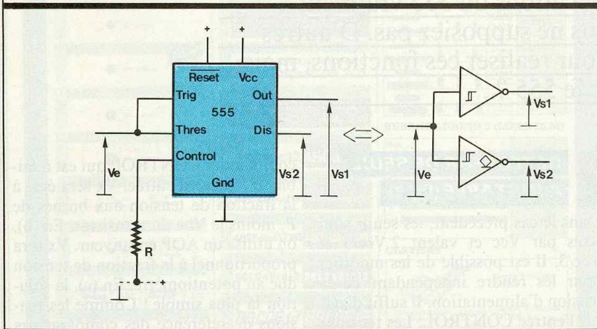
0,9 V et 1,8 V. R permettra d'ajuster cette valeur, quelle que soit la tension d'alimentation du 555. On notera que ces seuils seront toujours liés par un rapport de 2. OUT est la sortie normale, capable de fournir ou d'accepter un courant de 100 mA. Mais on dispose également de DIS, qui est à collecteur ouvert ! Donc deux inverseurs trigger !
