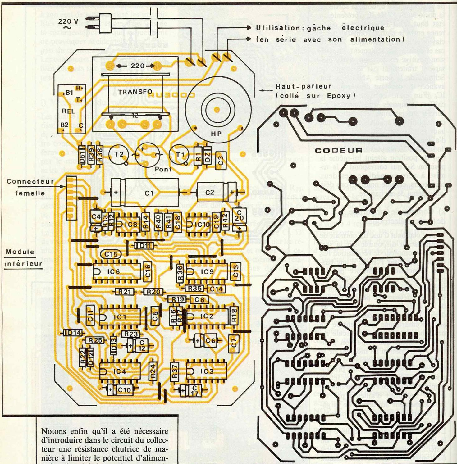
Fig. 5 et 6 Détails de réalisation du codeur.
