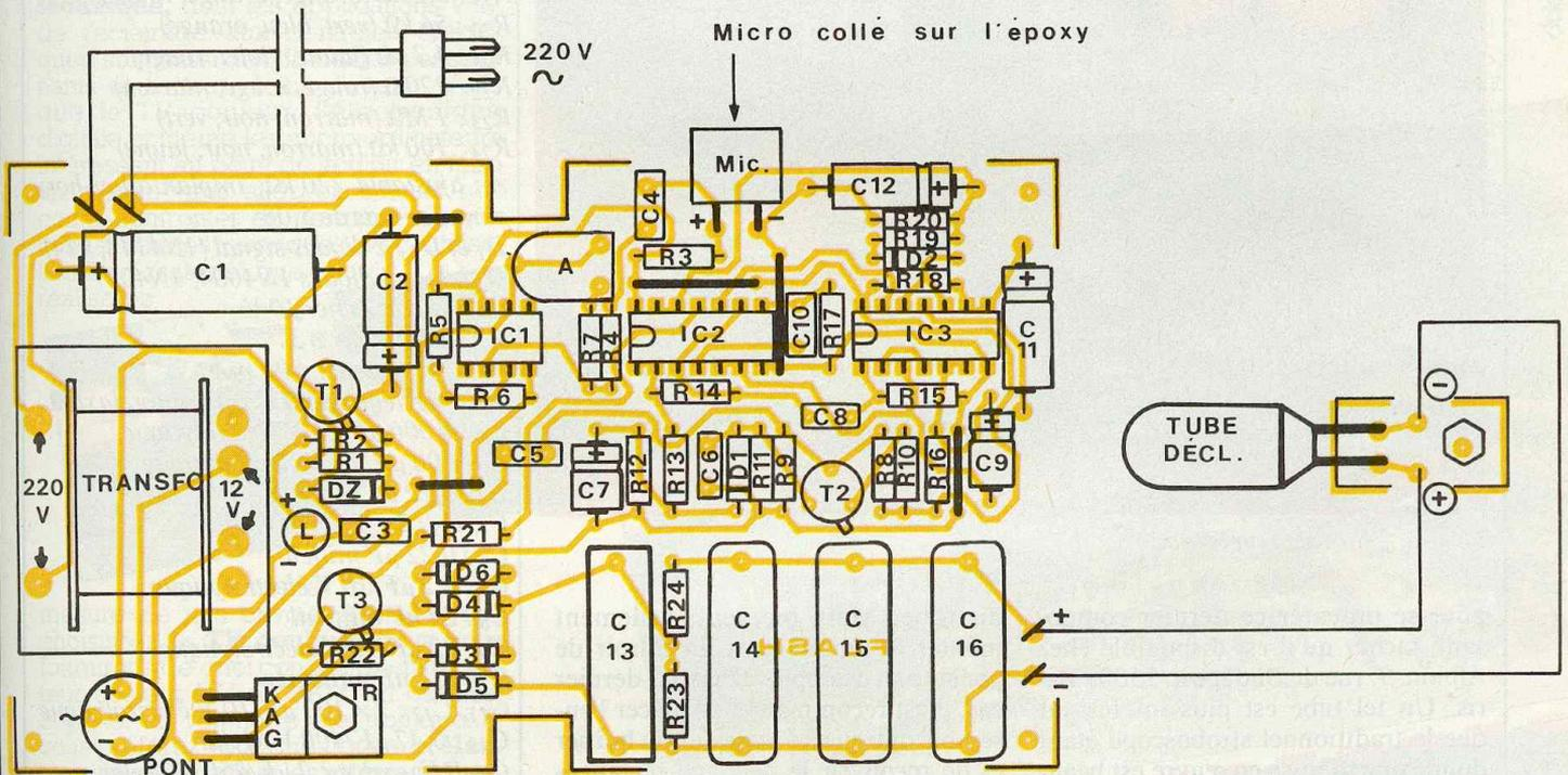
La fréquence des « flash » émis est de l'ordre d'un éclat à la seconde. La résistance R<sub>23</sub> de grande valeur permet à toutes les capacités de se décharger lors des repos de manière à ne pas les laisser inutilement sous tension.
