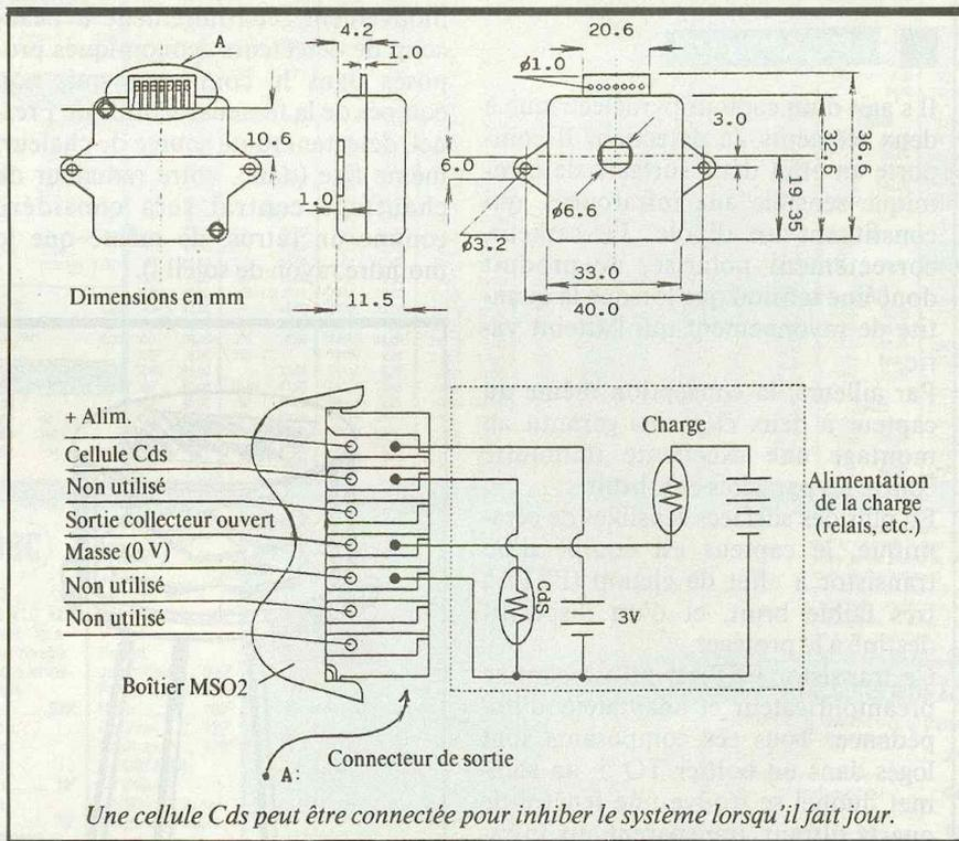
Une cellule Cds peut être connectée pour inhiber le système lorsqu'il fait jour.
