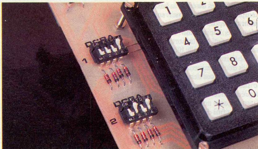
Photo 4. – Gros plan sur les « micro-switch ».
