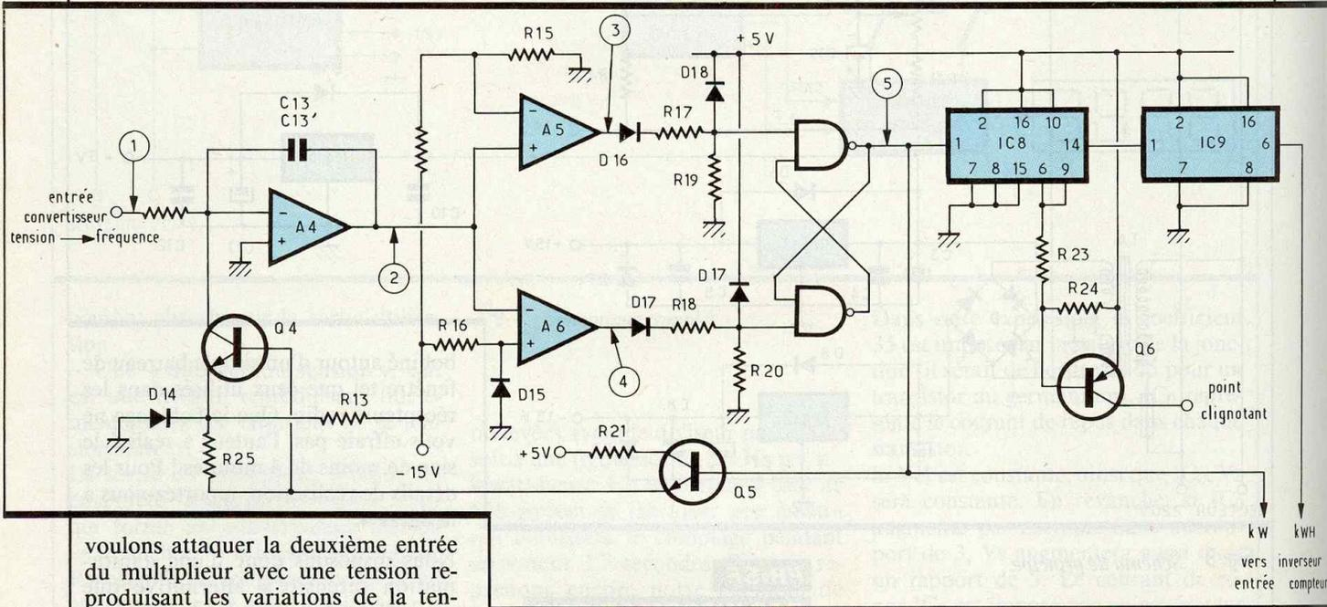
Fig. 5 Convertisseur tension/fréquence.
