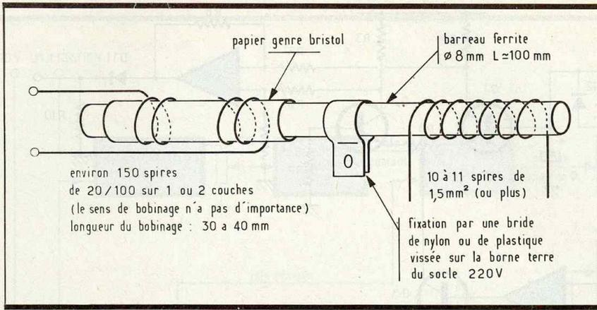
Fig. 4 Réalisation du transformateur d'intensité.
