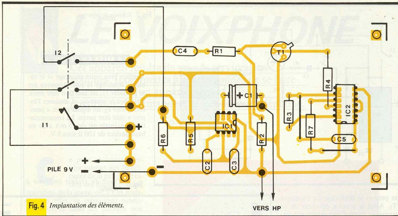
Fig. 4 Implantation des éléments.
