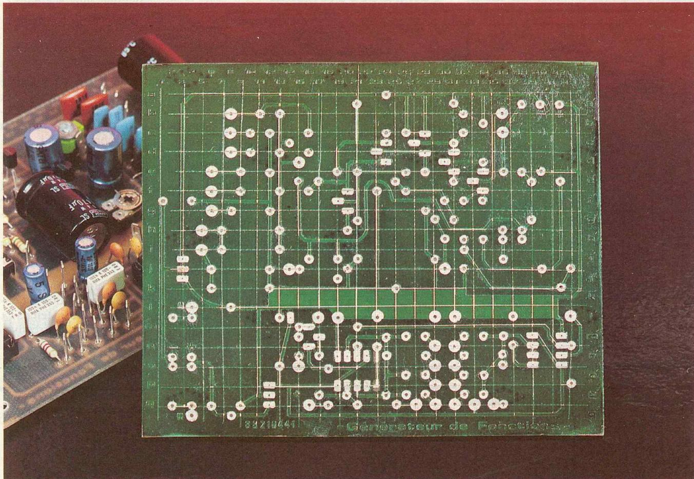
Photo 3. - Le circuit imprimé Electronique Collège.
