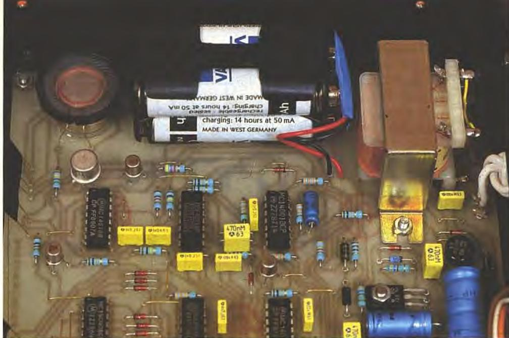
Photo 5. – Emplacement des accus de sauvegarde.
