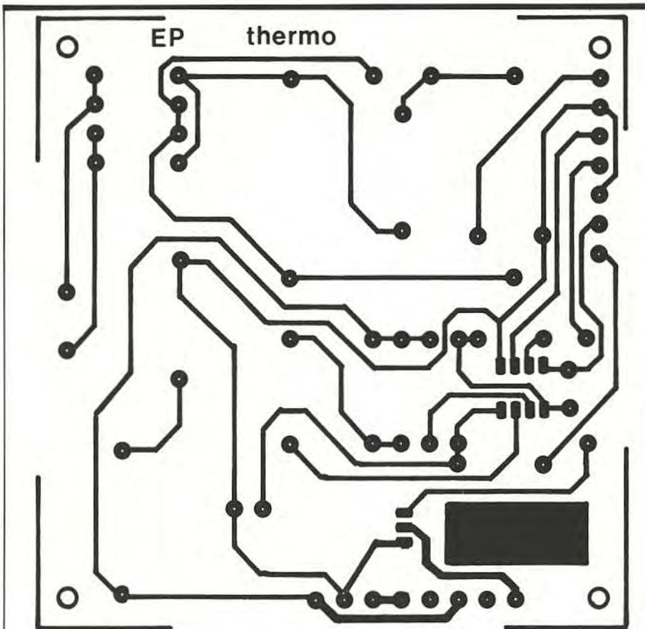
rappelle à l'utilisateur du fer à souder que le délai imparti sera bientôt écoulé. Il est vrai que le buzzer fonctionne assez longtemps (en fait un dixième du délai total soit environ 90 secondes !), mais il n'appartient qu'à nous de le faire taire en appuyant brièvement sur le poussoir. Cette action initialise à nouveau le compteur IC<sub>4</sub> et ne nous oblige donc pas à attendre l'extinction de la LED témoin.
