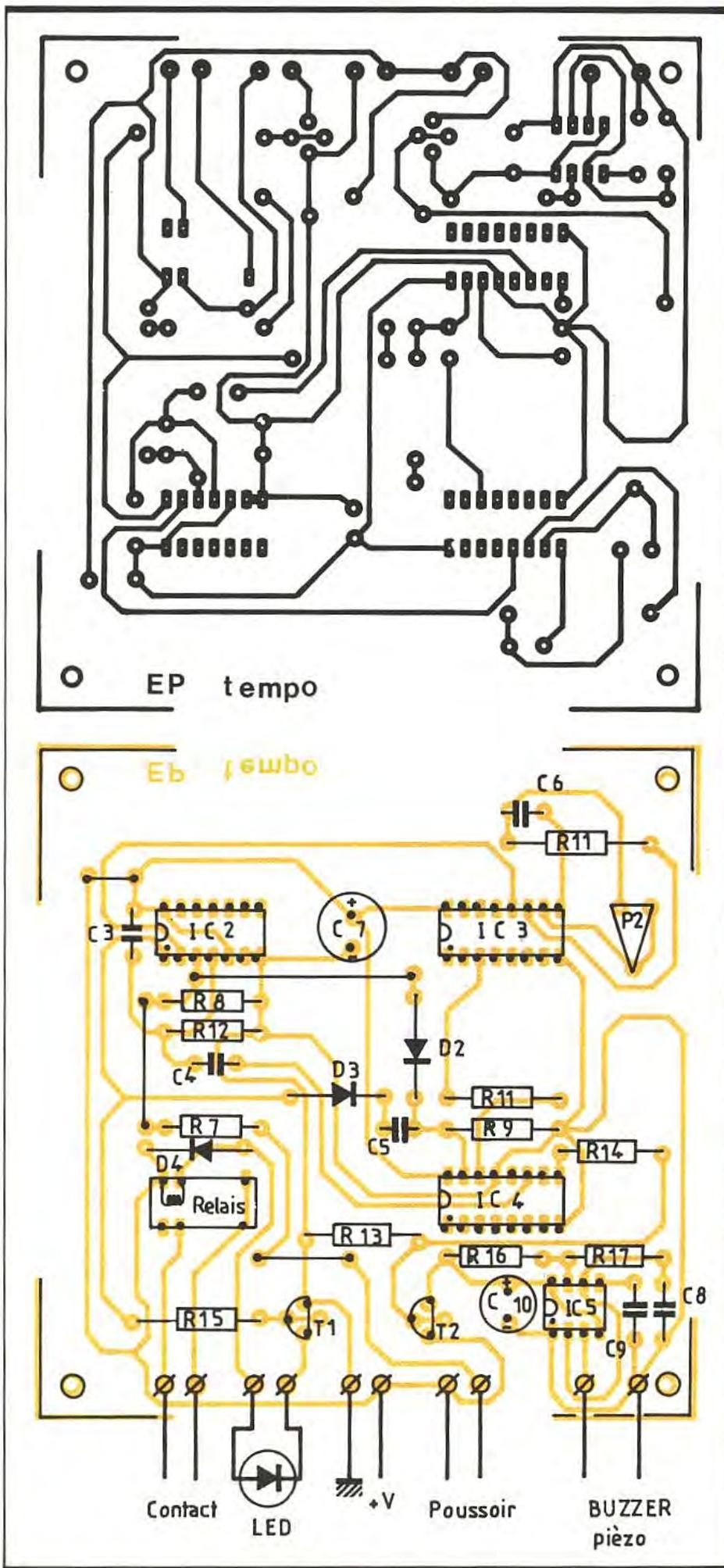
Fig. 6 et 7 Section temporisation de sécurité.
