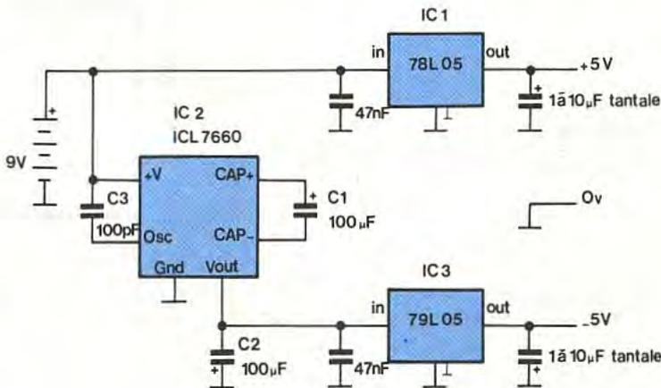
Fig. 7 Alimentation  $\pm 5$  V depuis une simple batterie.
