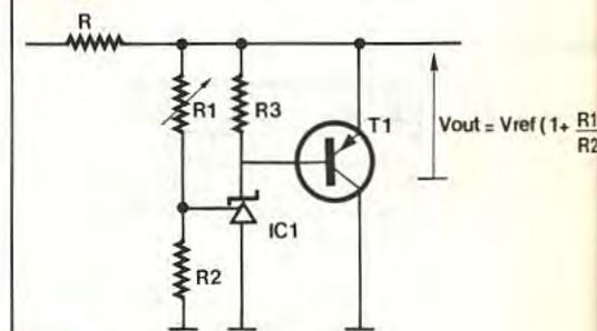
**Fig. 14** Régulateur shunt fort courant.
