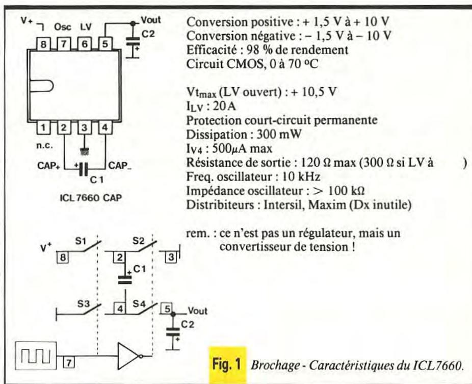
sion idéal. Pendant la première partie du cycle, les interrupteurs  $s_2$  et  $s_4$  sont ouverts et  $s_1, s_3$  fermés. Le condensateur  $C_1$  se charge à  $V^+$ . Pendant la seconde moitié du cycle,  $s_1, s_3$  sont ouverts et  $s_2, s_4$  fermés. On retrouve un potentiel de  $-(V^+)$  à la broche 4. La charge est transférée sur  $C_2$ , en considé-
