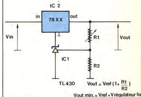
**Fig. 13** Contrôle d'un régulateur fixe.
