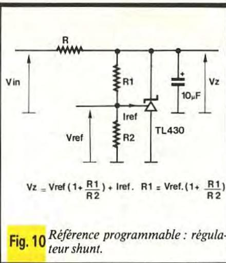
**Fig. 10** Référence programmable : régulateur shunt.
