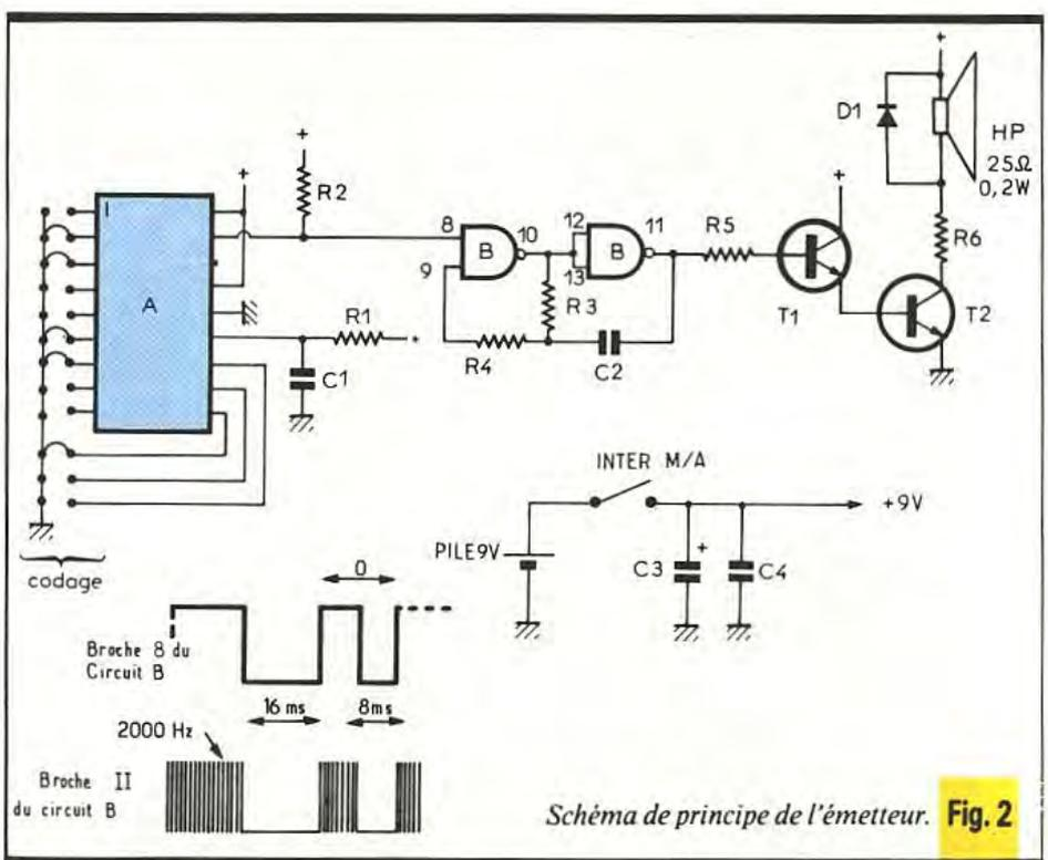
Schéma de principe de l'émetteur. Fig. 2
