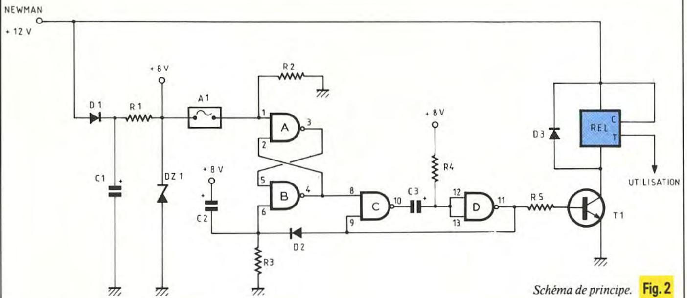
lais qui actionne l'avertisseur de bord et coupe le circuit d'allumage (option 2). Durant cette phase, la sortie 11 d'ici applique un niveau positif sur la patte 6 à travers D<sub>2</sub>, C<sub>2</sub> se décharge et la bascule, après avoir été remise à zéro, devient inopérente. Ceci à pour effet de pouvoir réarmer le circuit en laissant l'entrée 8 au ni-
