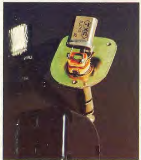
Détails pratiques de montage du quartz.
