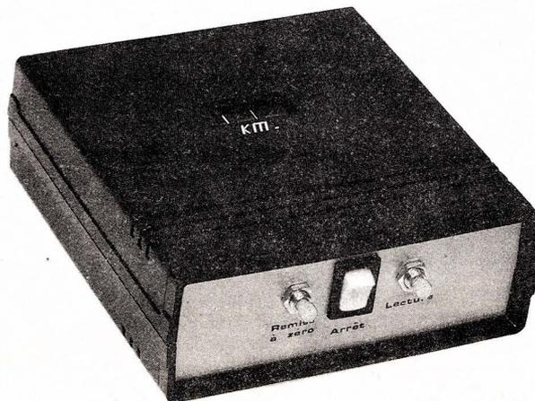
elle a l'avantage d'être isolée par rapport à sa fixation, ce qui n'est pas le cas d'une embase Cinch par exemple. Enfin, l'interrupteur de mise en marche et les deux boutons-poussoirs peuvent être fixés sur la face avant du boîtier.
