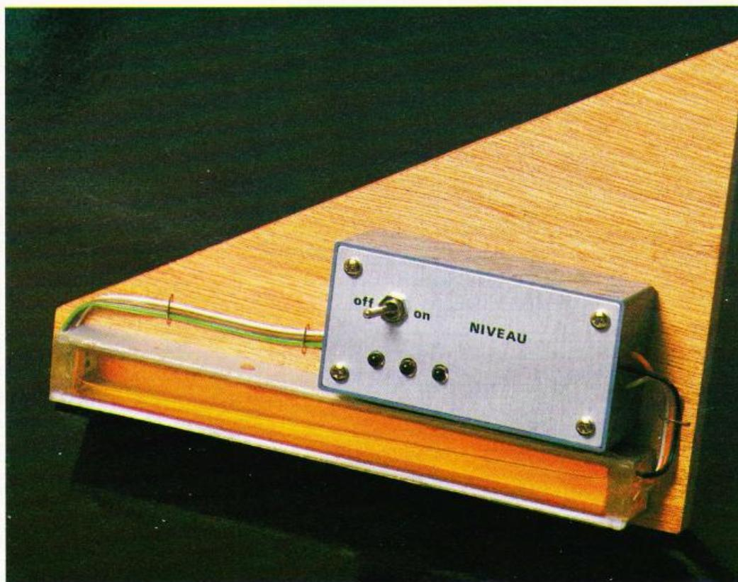
**L**e niveau électronique présenté ici est sans équivoque, puisque l'affichage à diodes électroluminescentes détermine la précision. Le niveau n'est correct que si la LED verte est allumée. Deux autres LED rouges s'allument si le niveau est trop penché à
