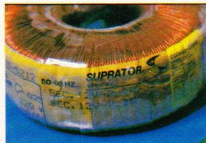
**E**n effet, le flux magnétique demeure concentré dans le noyau d'une façon uniforme, grâce à l'absence d'entrefer et à la technologie du noyau. D'autre part, la tôle employée comme noyau, en fer-silicium à grain orienté de haute perméabilité, facilite et guide le passage du flux magnétique.
