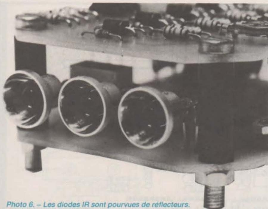
Photo 6. — Les diodes IR sont pourvues de réflecteurs.
