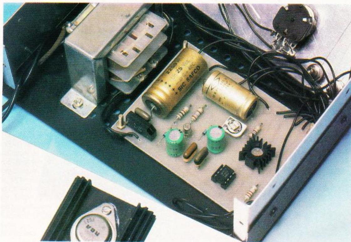
Il est quelquefois utile de disposer d'une petite alimentation pour alimenter un poste de radio par la prise auxiliaire ou bien d'autres appareils encore. Il existe sur le marché bon nombre de petites alimentations prévues à cet effet. Malheureusement, elles présentent souvent un gros défaut : la tension de ronflement devient vite importante en charge.
