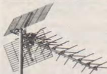
L'antenne Active LAMBDA V, 9 directeurs, permet la réception des canaux UHF à grandes distances, ou en périphérie des zones normalement couvertes. L'antenne est équipée d'un amplificateur à gain élevé (44 dB ± 1), et de faible souffle, rapport avant/arrière 24 dB - Référence de l'antenne 440.09, canaux au choix : 21 à 33 ou 37 à 47 ou 48 à 65, fournie avec alimentation 24 volts appropriée. Documentation sur demande.
