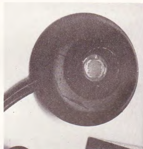
Photo 4. – Encapsulation de la cellule photo-résistive.
