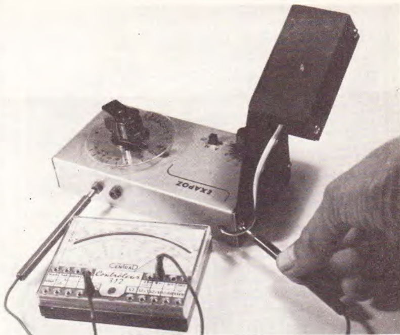
Photo 5. — On peut vérifier les piles sans démonter le couvercle.
