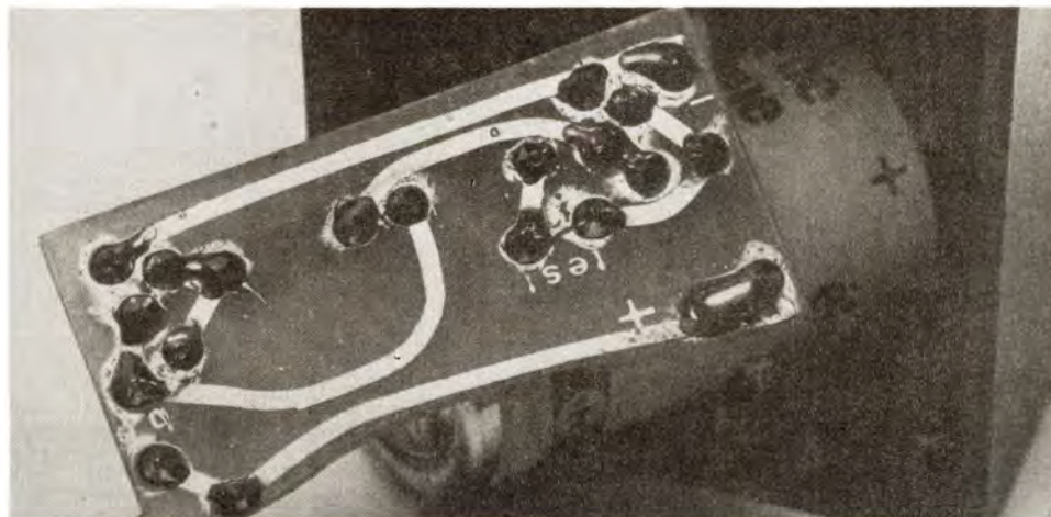
Fig. 5. et 6. – Le montage se logeant dans le boîtier Teko P/1, ses dimensions se devaient d'être très réduites. Tracé et implantation figurent à l'échelle 1.
