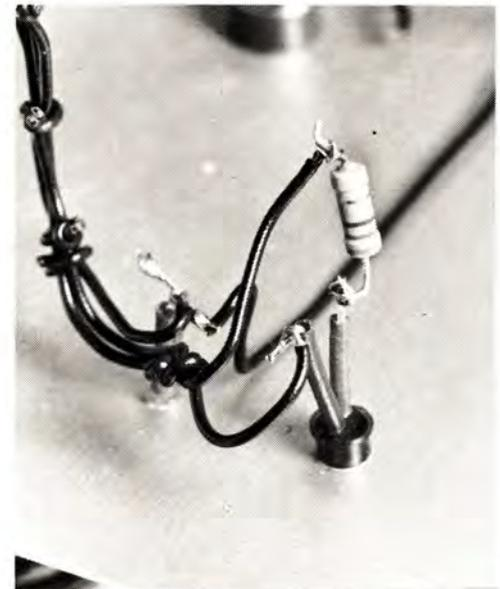
*Photo 7. – Mise en place très simple du témoin lumineux avec sa résistance de limitation.*
