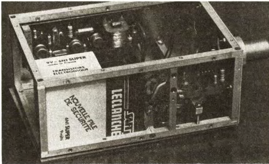
Photo 2. – Section générateur haute tension mettant en évidence le bobinage. On remarque également que C_2 se monte directement sur l'interrupteur.
