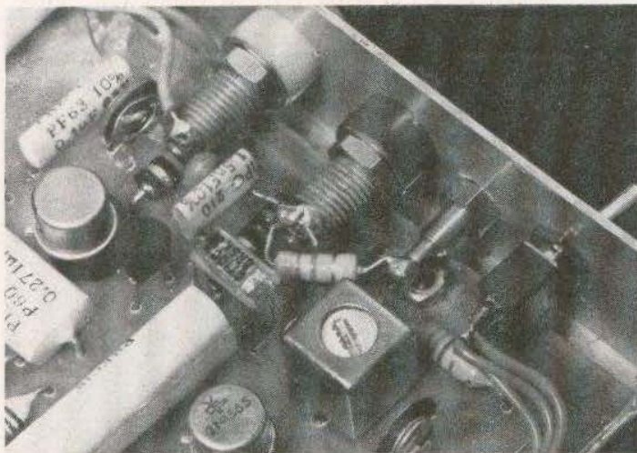
Photo 2. - Certains composants seront montés extérieurement au circuit imprimé.
