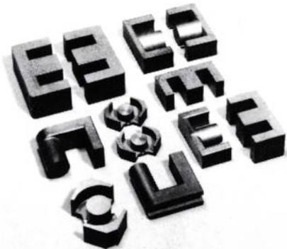
La première amélioration porte sur l'induction de saturation au-delà de 25 °C : un matériau classique présente en effet une induction de saturation de l'ordre de 4 700 gauss à 15 Oe et à 25 °C ; or, à 50 °C, cette induction passe à 4 300 gauss, puis 3 800 gauss à 75 °C, 3 200 gauss à 100 °C et moins de 3 000 gauss à 125 °C. En moyenne, à haute température, le B52 offre 20 % de mieux : 4 800 gauss à 25°C, 4 600 gauss à 50 °C, 4 400 gauss à 75 °C, 4 000 gauss à 100 °C et 3 500 gauss à 125 °C.
