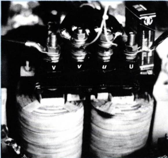
Fig. 8 : Transformateur 50 KVA, 20 kHz.
