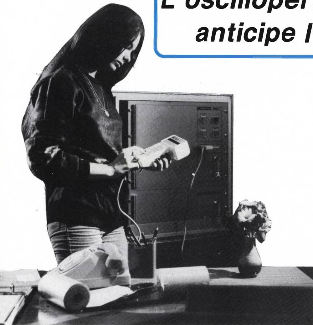
*Conçu initialement pour la surveillance de réseaux de distribution d'énergie, l'oscilloperturbographe permet la détection et l'analyse des incidents, avant, pendant et après leur apparition. Susceptible de mesurer toute grandeur pourvu qu'elle soit traduite en grandeur électrique, logique ou analogique, cet appareil trouve tout naturellement des débouchés dans les laboratoires.*
