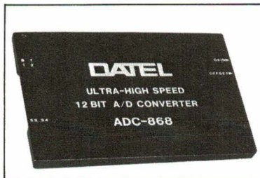
Modèle ADC-868 12 bits / 500 ns.
