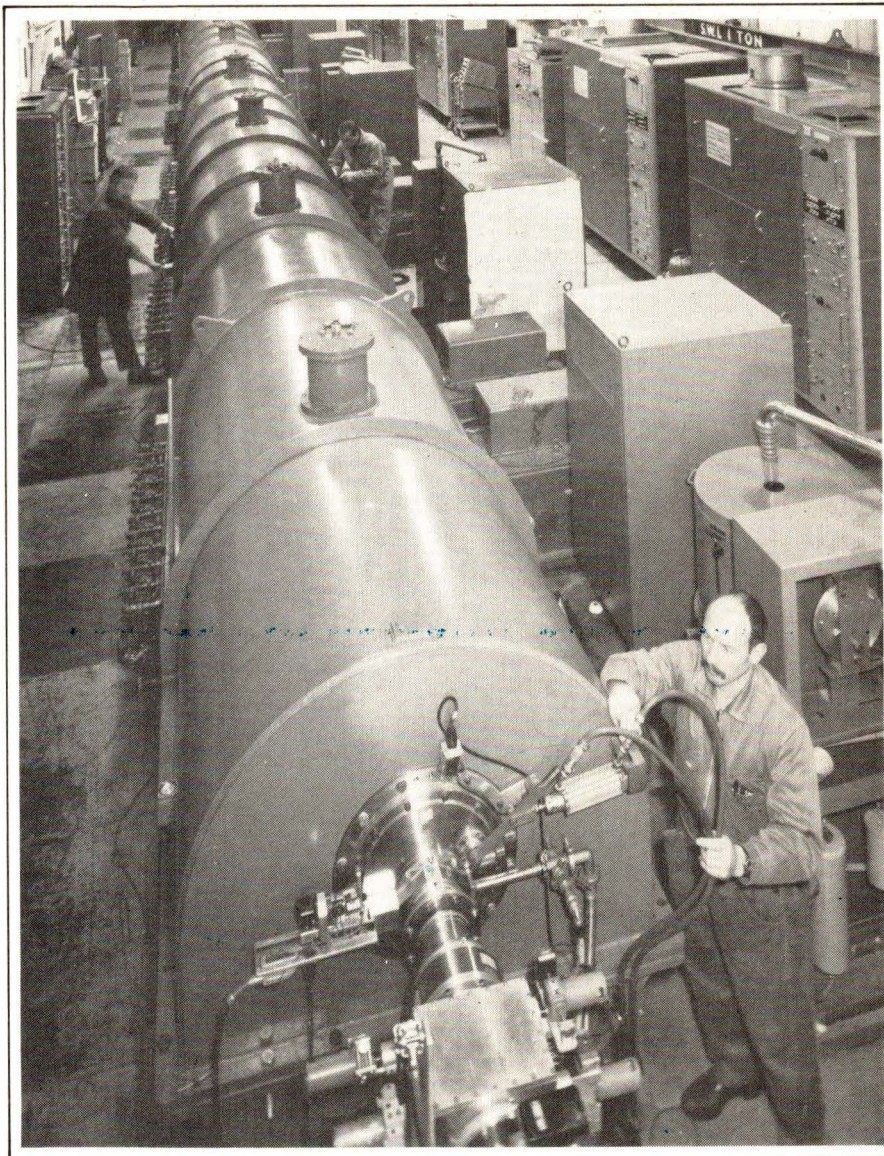
Fig. 8. - Vue de l'accélérateur linéaire (type Alvarez) de 50 MeV, prise depuis la zone d'éjection. Les tubes de glissements à l'intérieur des trois cavités de résonance, accélèrent les protons depuis 500 keV dans le générateur Cockroft-Walton à haute tension continue à la source d'ions jusqu'à 10 MeV dans la première cavité, 30 MeV dans la deuxième cavité, pour atteindre l'énergie maximum de 50 MeV dans la troisième cavité.
