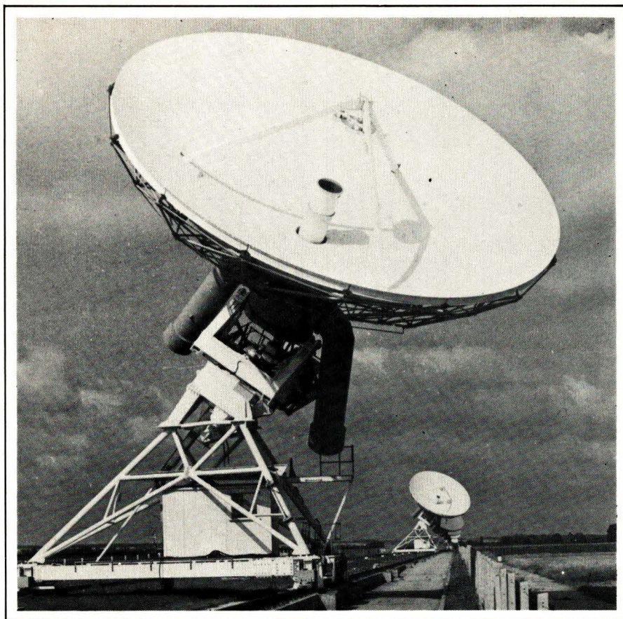
Fig. 33. - Le radiotélescope de 5 km de Cambridge. En combinant ses 8 antennes, il est possible de constituer 16 interféromètres simultanés de base différentes. C'est avec de tels instruments que l'on obtient actuellement des cartes complètes des radiosources extragalactiques à très haute résolution angulaire (doc. Cavendish Laboratory Cambridge).
