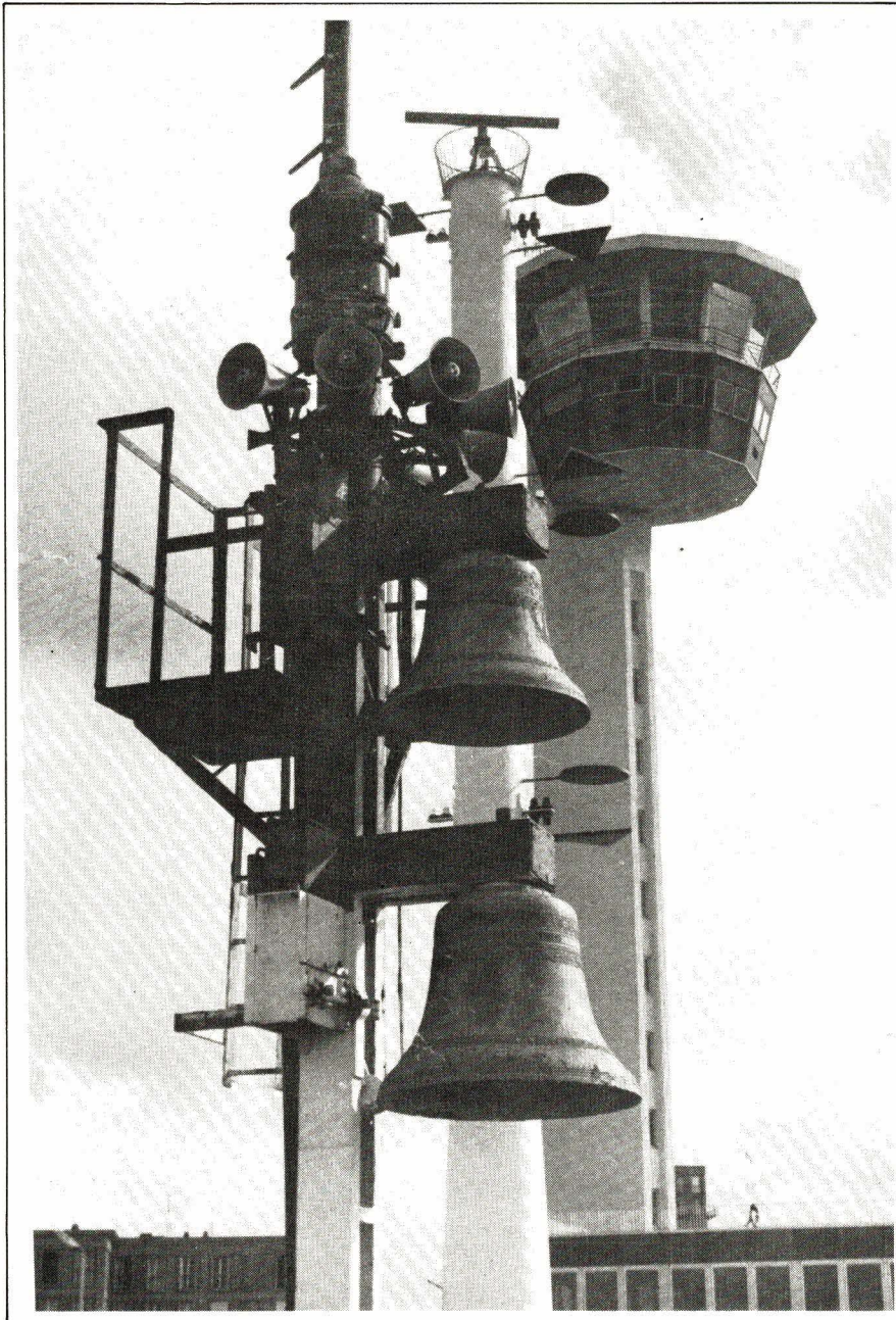
Le mât de signaux supportant l'antenne radar locale est situé à peu de distance de la tour de la vigie. A proximité, les installations annexes telles que cloches de brume, haut-parleurs de transmission d'ordres et équipements météo.
