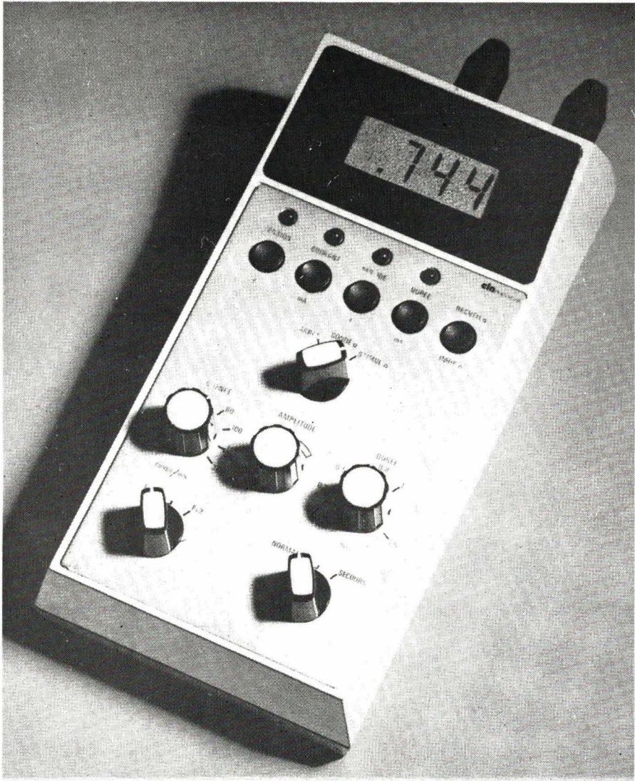
Fig. 9. – Un appareil destiné au chirurgien. Cet appareil permet la mesure, lors de l'implantation, des paramètres de stimulation (seuil de stimulation en particulier) et la vérification des stimulateurs avant et après implantation. (Photo ELA Médical).
