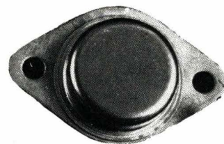
Présentation boîtier transistor type TO3
