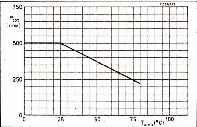
Dissipation de puissance du circuit en fonction de la température ambiante.
