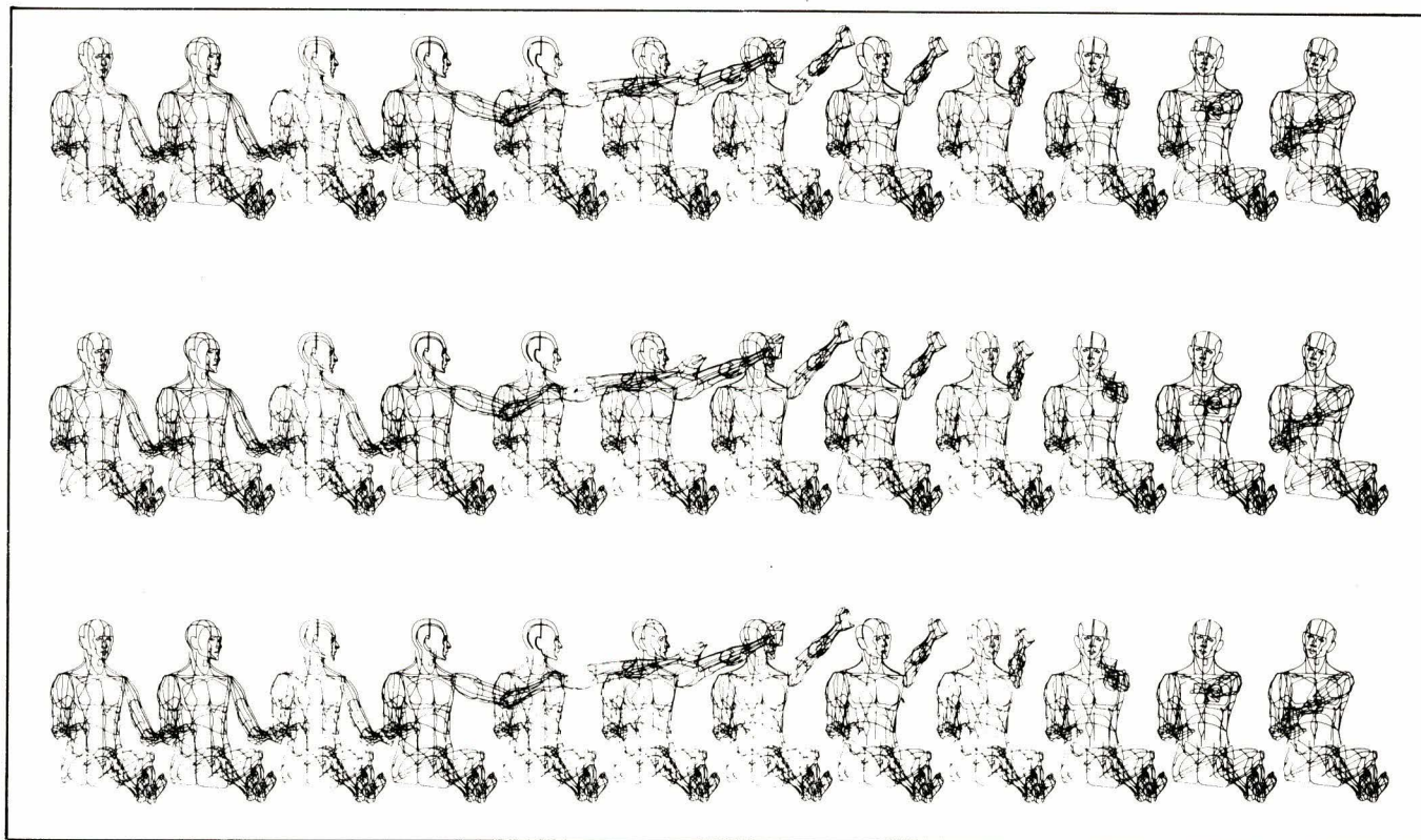
Fig. 1. — Exemple de simulation. Cette séquence, réalisée par Boein Computers Graphics, représente l'étude sur ordinateur des évolutions d'un pilote dans un cockpit. (Document : Cahier SESTA n° 5, oct. 1973).
