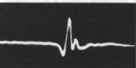
Fig. 5c : Réponses typiques de tweeters à une impulsion de  $40\mu\text{s}$  (récurrence 300 Hz). En haut : tweeter mal amorti. En bas : tweeter de bonne qualité.
