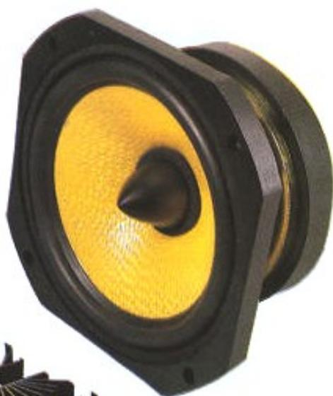
(rendement fabuleux) sur support Kapton (tient beaucoup mieux la température), son noyau bagué cuivre (baisse de distorsion par harmonique 2) et... sa colossale ferrite de 13,5 cm procurent un détail, une présence, une ouverture (très bien l'ogive centrale) qui bouleverseront les plus blasés en matière de haut-parleur médium de haute définition.
