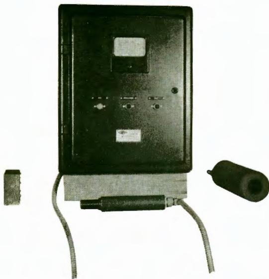
Fig. 9. Appareil Mesco qui permet la commande asservie des dispositifs d'enfournement en fonction de l'intensité de rayonnement détecté par le compteur Geiger-Muller que l'on voit au-dessous.
