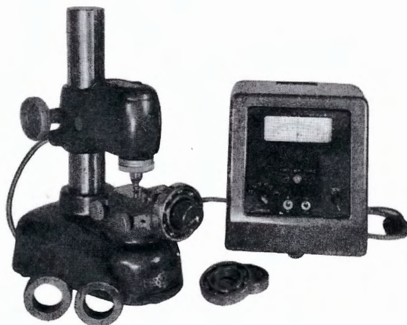
Fig. 12. Comparateur Manubel, construit par la Manurhin, utilisé pour le contrôle de l'alésage d'un roulement.
