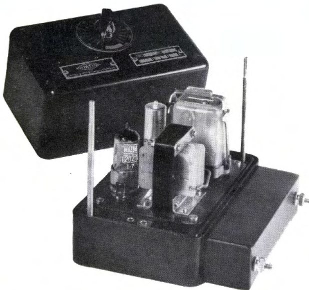
Fig. 11 - Temporisateur électronique industriel. (Document M.T.I.).
