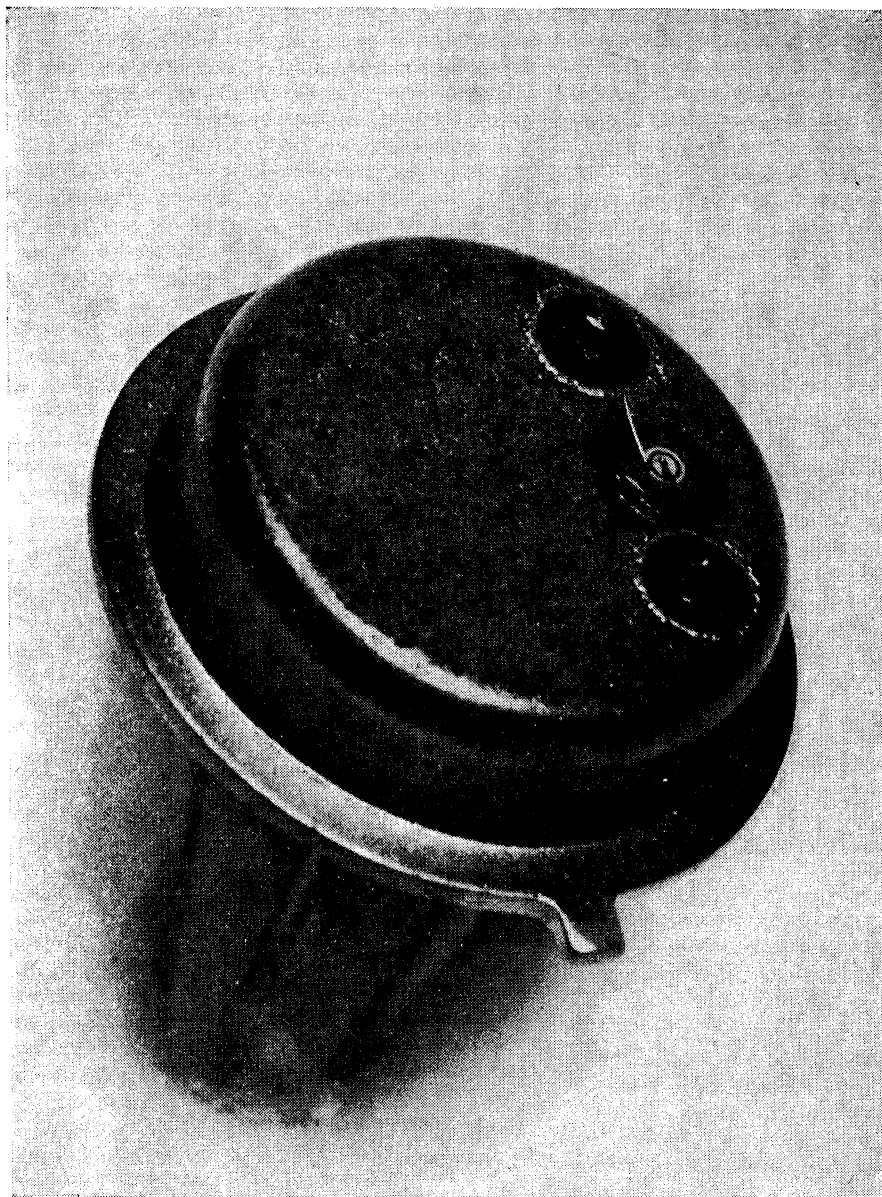
Fig. 17-9. — Vue grossie avant capotage d'un transistor planar épitaxial n-p-n, type 2N2192 sur une embase TO5 de 8,25 mm de diamètre. On voit le faible encombrement de la pastille de silicium (Sesco).
