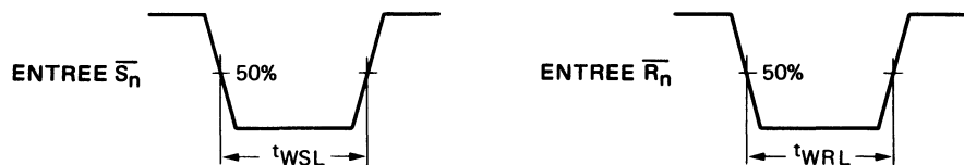
Fig. 5 Chronogrammes montrant la largeur minimale des impulsions \overline{S}_n et \overline{R}_n .
