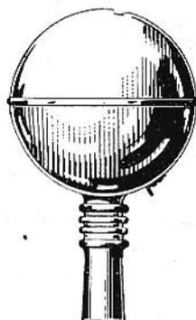
Collecteur d'ondes « Diélasphère » à grande capacité de réception — parfait isolement — garantie contre la foudre, non directive. Boule aluminium diamètre 35<sup>m</sup>/<sub>m</sub>, poids 1 kil. 300. Son emploi est recommandé sur un bambou ou mât de 4 à 5 mètres et descente antiparasite (voir dispositif ci-contre). La « Diélasphère » est livrée montée sur isolateur porcelaine... N° 1455
