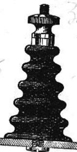
**Colonnnette porcelaine,** convenant pour assurer l'isolement tant à l'émission qu'à la réception, tels que circuits oscillants, bornes, etc. Ligne de fuite très allongée. Partie supérieure terminée par une tige de 4  $\frac{m}{m}$  avec bouton moleté. Base munie d'un filetage de 3  $\frac{m}{m}$ , long. 20  $\frac{m}{m}$ , avec écrou de serrage. Hauteur totale 6  $\frac{m}{m}$ . N° 2783
