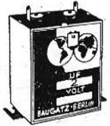
Série Haute Tension pour Emission, diélectrique papier paraffiné. Les tensions d'isolement indiquées sont celles d'essai en courant continu pendant une minute. En général il faut adopter un coefficient de sécurité de minimum 3 × (pour 1000 volts de service : 3000 volts d'isolement). Boîtier métallique, pattes de fixation.
