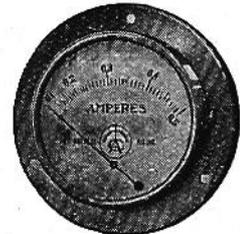
Ces appareils conviennent pour des mesures en haute ou basse fréquence. Ils sont spécialement recommandés pour les mesures de haute fréquence comme ampèremètres ou milliampèremètres d'antenne pour les postes d'émission.
